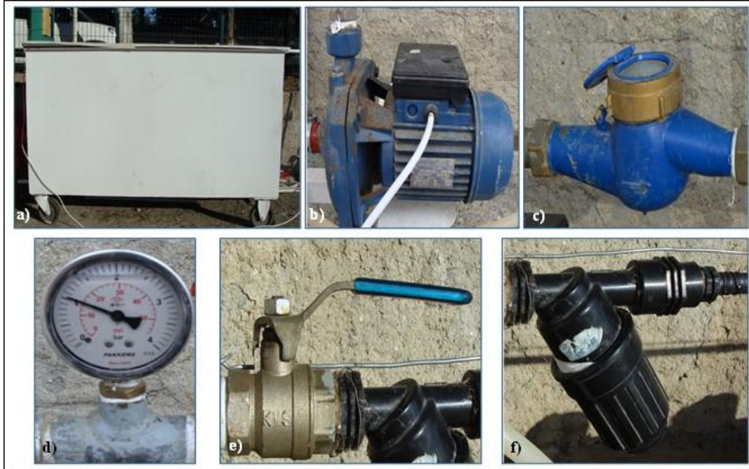
Şekil 3.4. Test masasını oluşturan ögeler: a) Su deposu, b) Santrifüj pompa, c) Su sayacı, d) Manometre, e) Küresel vana f) Filtre
