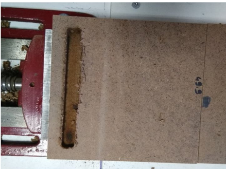
Şekil 4.2. 6 mm dalma derinliğinde 16000 d/dk bıçak motor hızı ve 1 m/dk besleme hızında test örneğinde meydana gelen yanma
