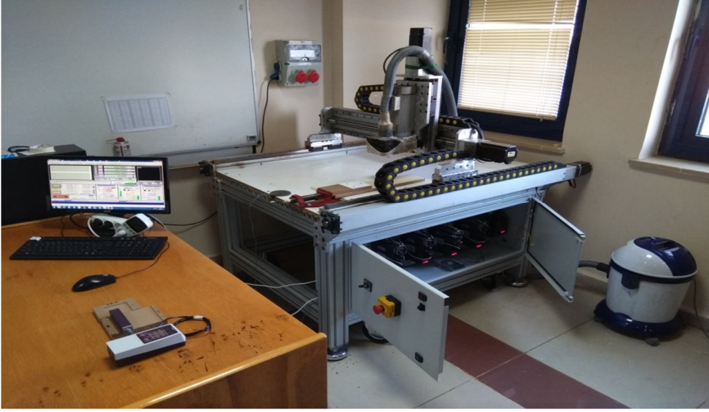
Şekil 3.1. CNC makinesi, bilgisayar kontrolü
