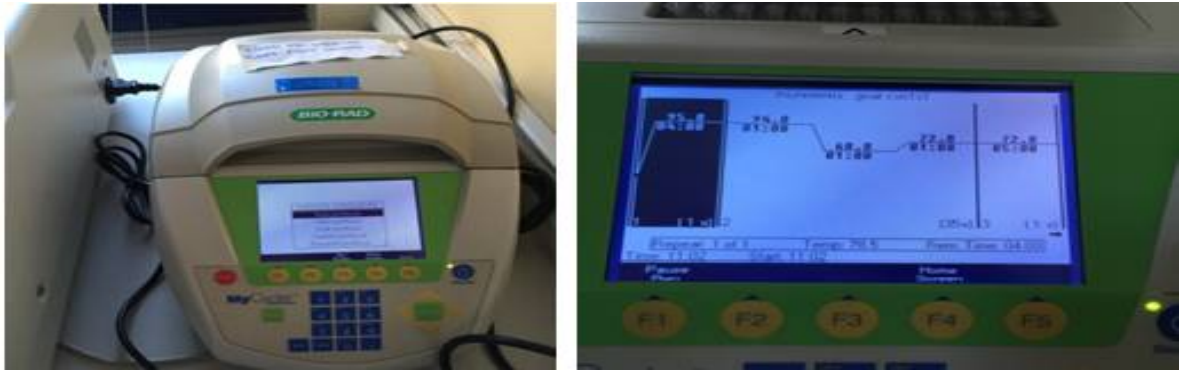
Şekil 3. 4. Thermal Cycler (BioRad) ve PZR protokolü
