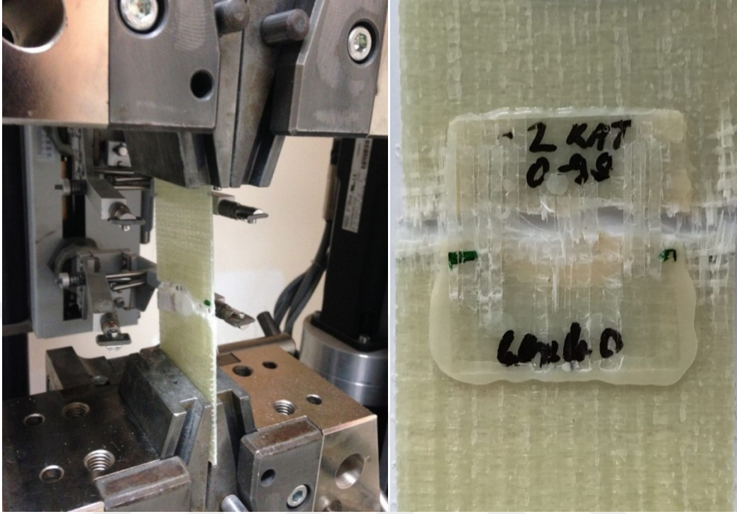
Şekil 4.15. Tabaka sayısı 2 olan yamalarda görülen elips kesitinden kopma anı
