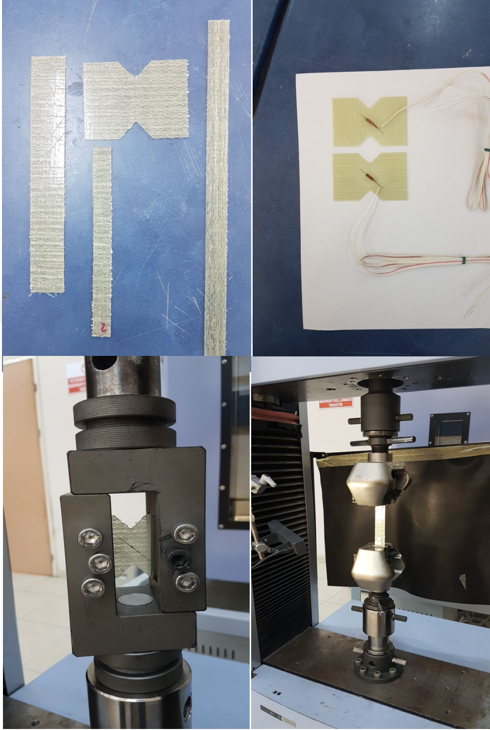
Şekil 3.4 ASTM standartlarına göre üretilmiş ve test aşamasındaki numuneler
