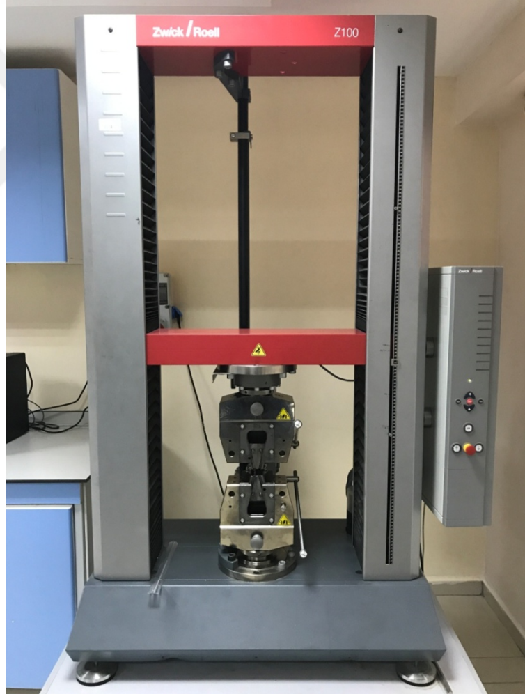
Őekil 2.9. ZWICK test cihazı
