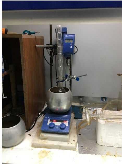
Şekil 4.2. Klasik teknik ile kimyasal modifikasyon yöntemi
