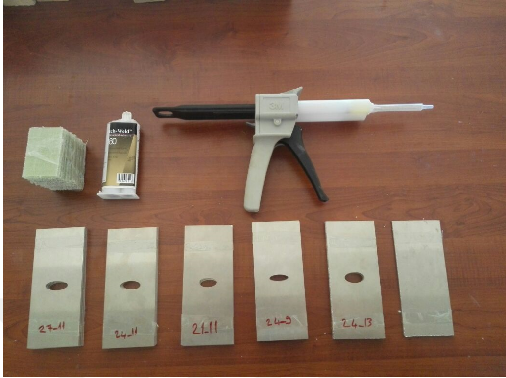
Şekil 3.5. Kompozit yamalar, DP460 yapıştırıcı, yapıştırıcının tabancası üzerinde nozüle takılmış hali ve hasarsız ve eliptik hasarlı Al 2024 T3 malzemeler
