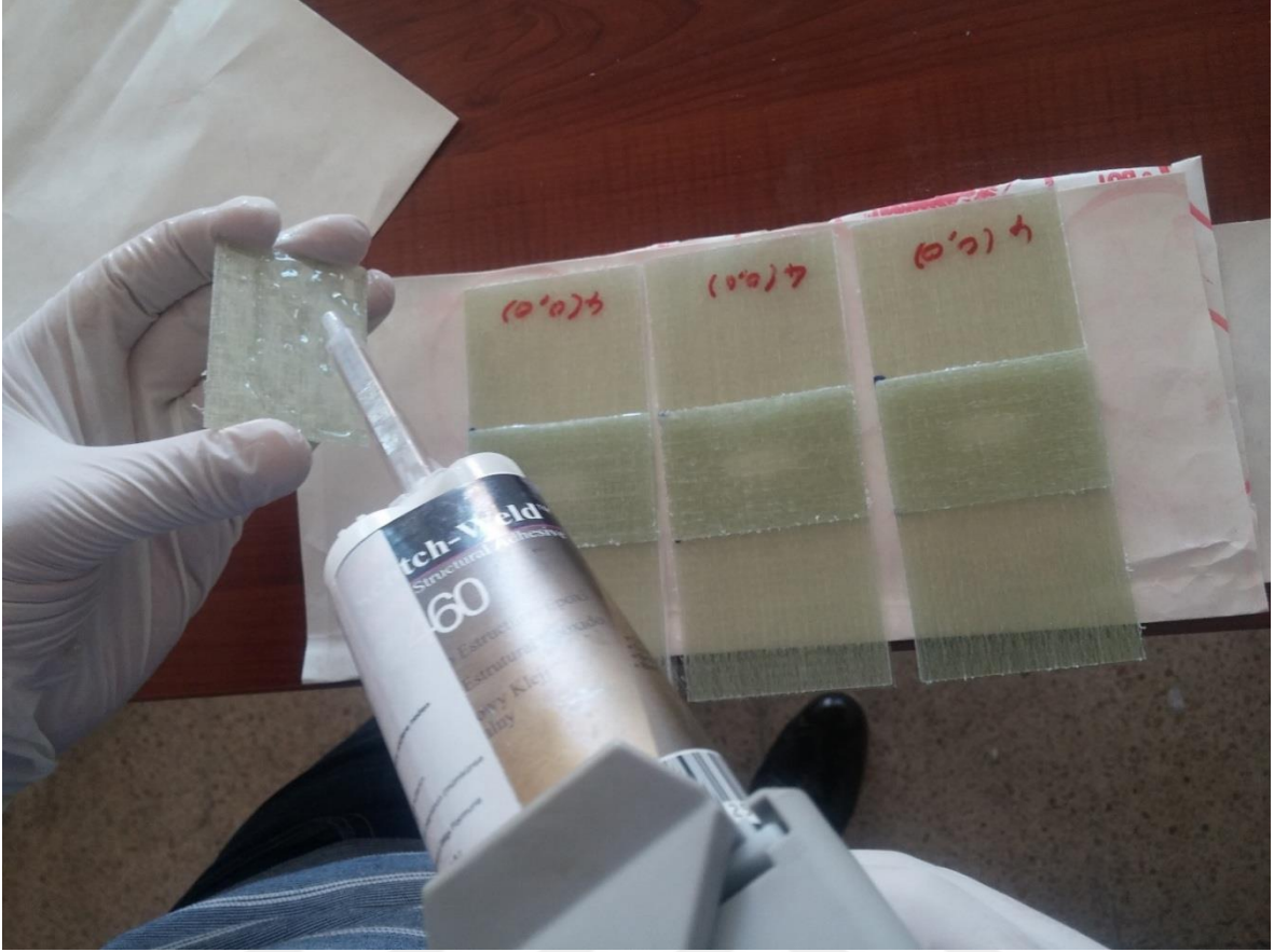
Şekil 3.9. Yapıştırıcı uygulanan numuneler
