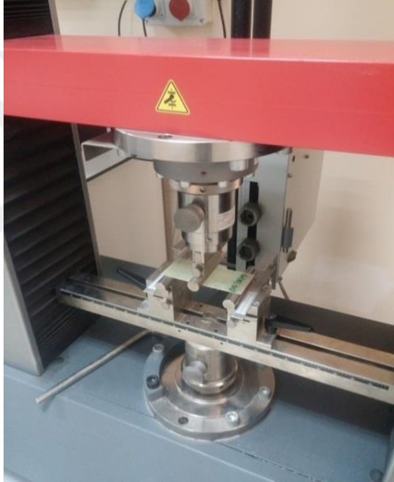
Şekil 3.13. ZWICK Z100 test cihazı
