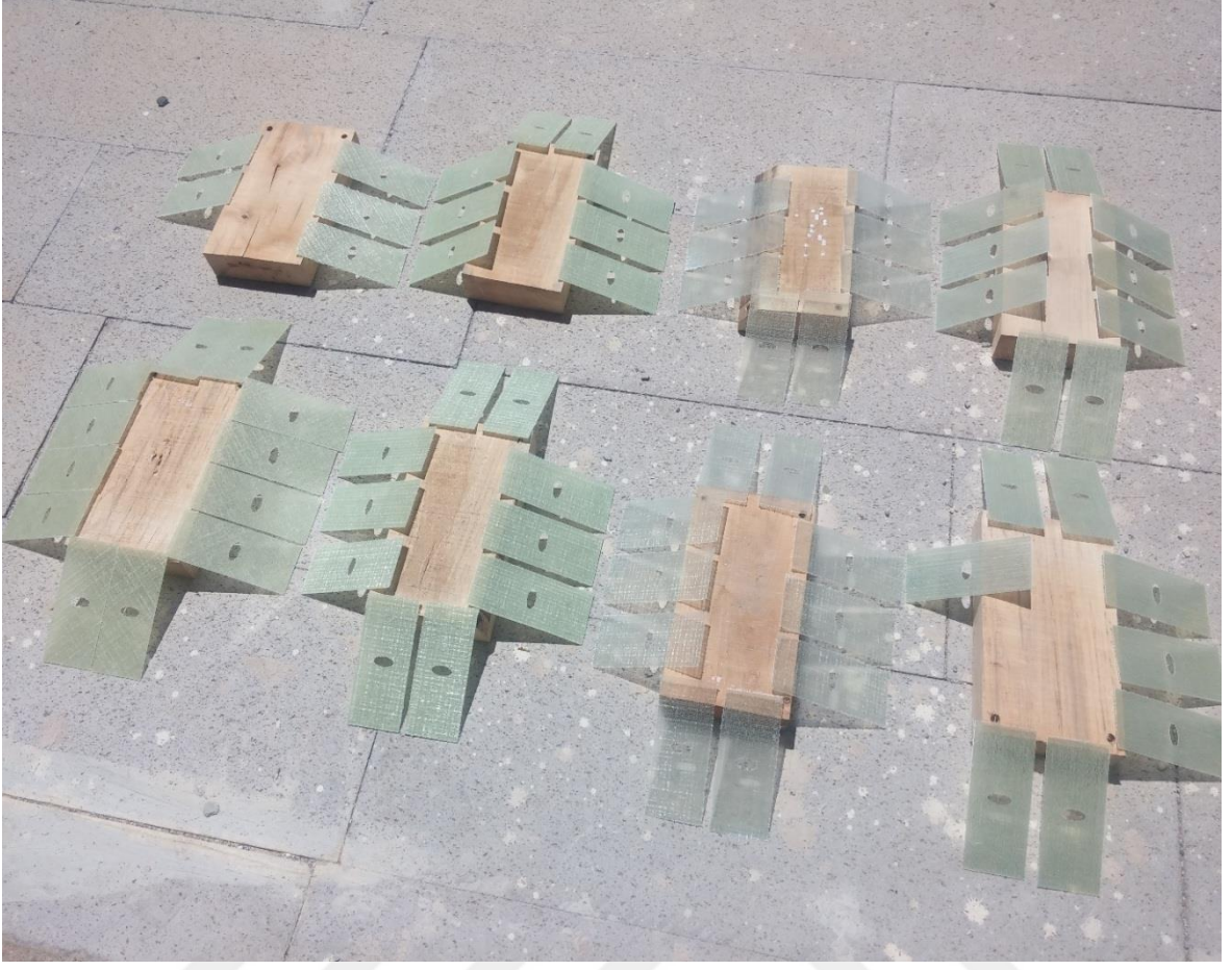
Şekil 3.8. Asetonla yıkanıp su ile durulanan numunelerin kurutulması işlemi
