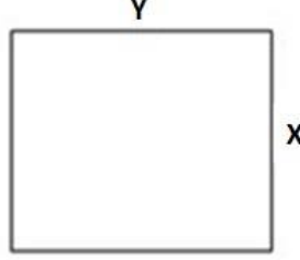
Şekil 3.3. Cam elyaf kompozit yama malzemesi x=60, y=40 mm
