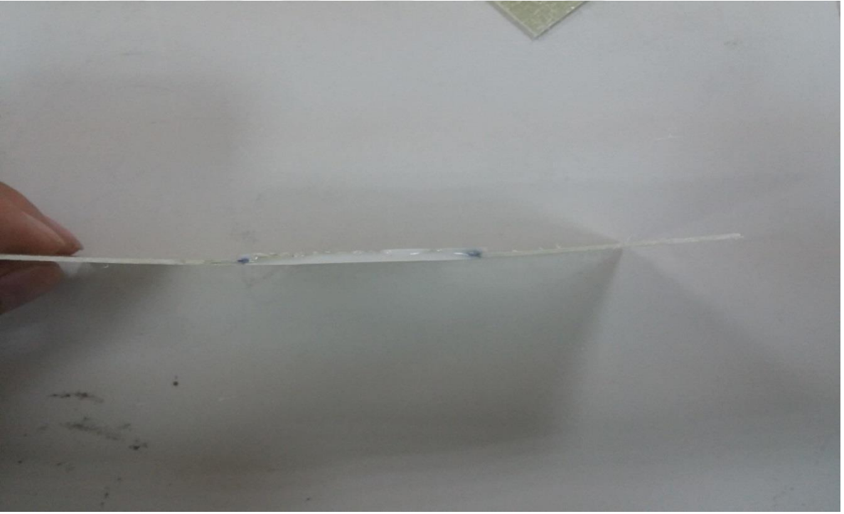
Şekil 4.12. Tek taraflı bindirme uygulanan 4 tabaka (0,0) numunenin deney sonrası hasar tipi ( yama yanından )
