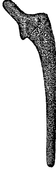
Şekil 2. % 30 karbon fiberle kuvvetlendirilmiş kompozit kalça protezi.
