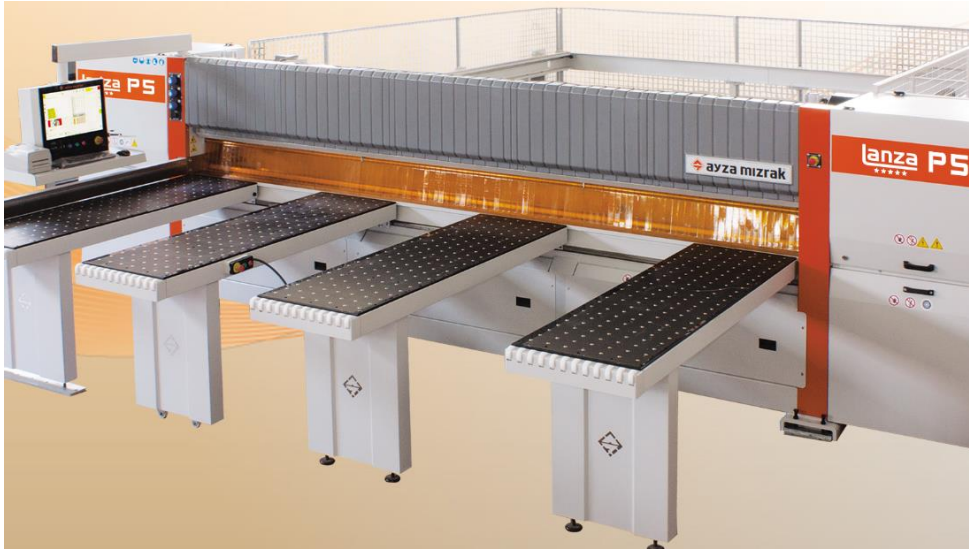
Şekil 0.5 CNC’li panel ebatlama makinesi (URL4, 2018)
