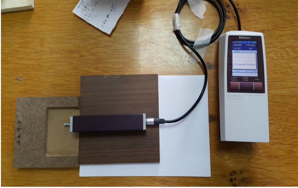
Şekil 0.6. Mitutoyo SJ-210 model pürüzlülük ölçüm cihazı ve test örneği
