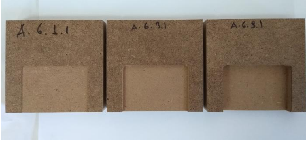
Şekil 0.3 Farklı derinliklerde (1, 3 ve 9 mm) işleme yapılan test örnekleri
