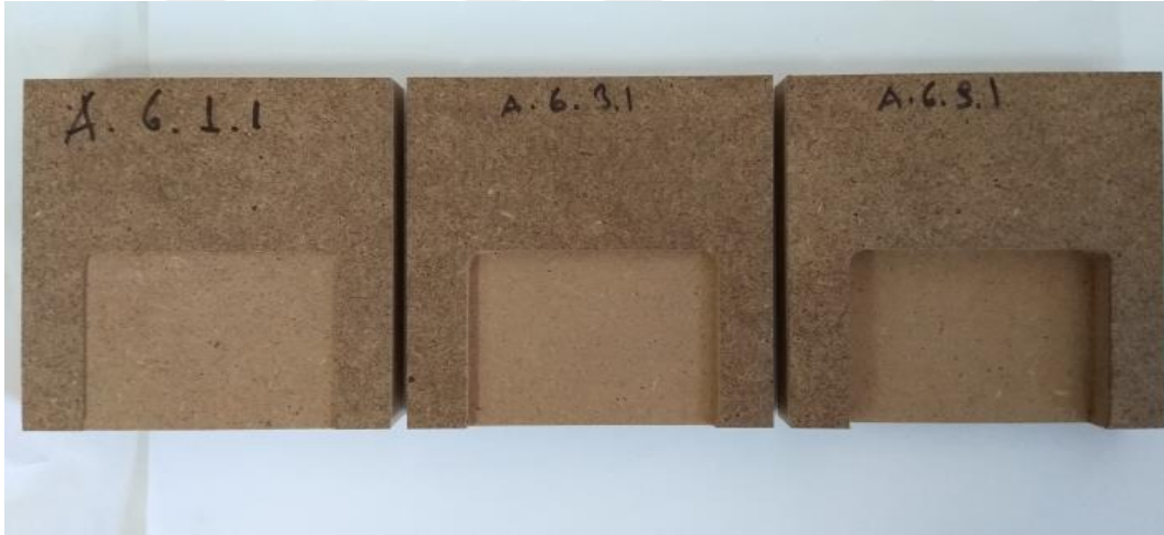
Şekil 0.1. Dalma derinliği 1, 3 ve 9 mm olan test örneklerinin görüntüsü
