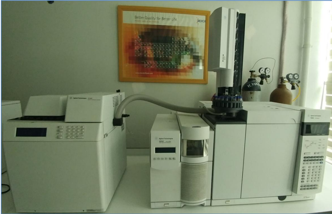
Şekil 2.13. Gaz kromatografisi cihazı (GC-MS)
