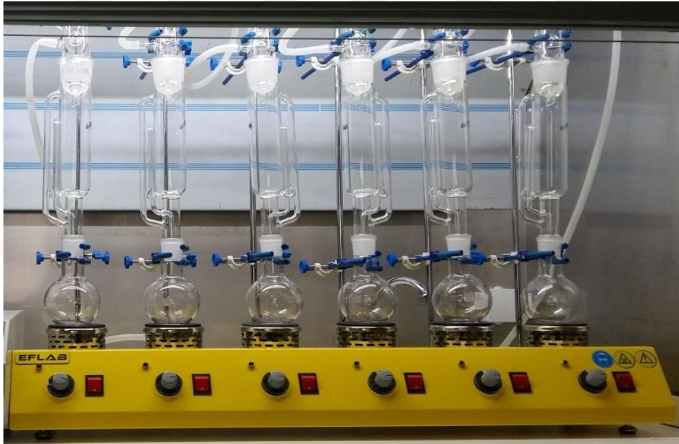
Şekil 2.4. Ekstraksiyon cihazı (Soxhlet cihazı)
