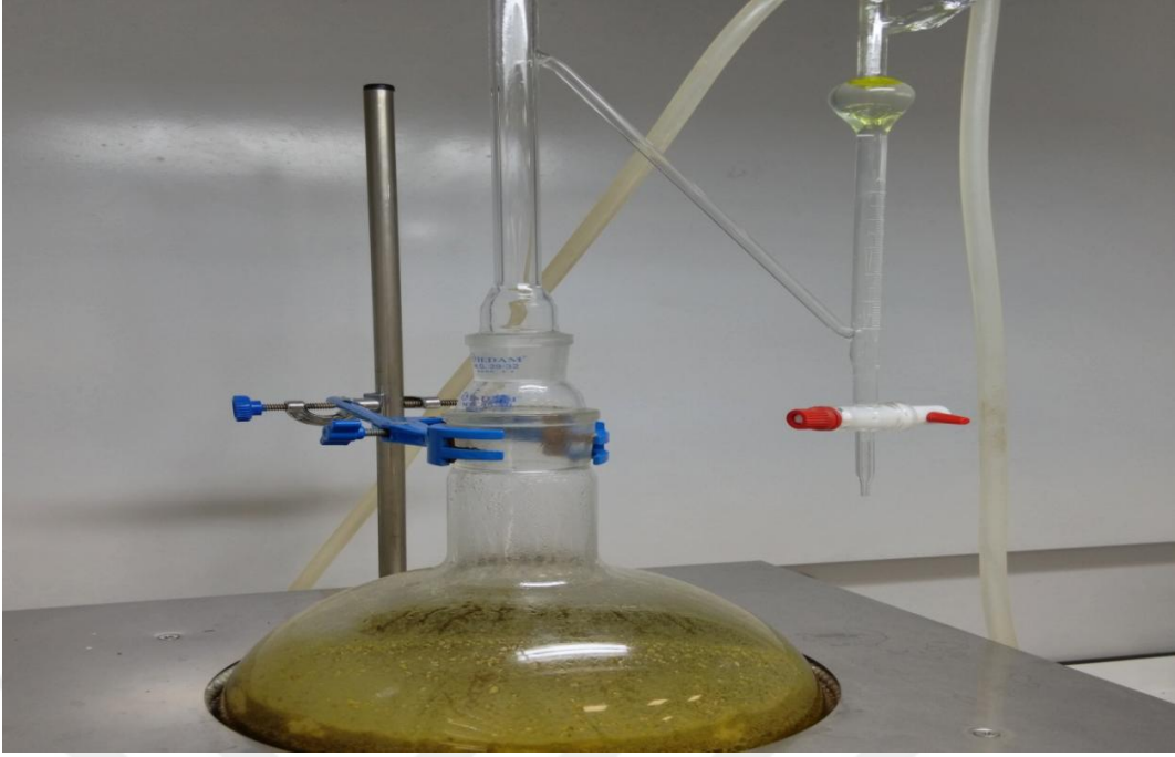
Şekil 2.12. F.longipedunculata bitkisinden uçucu yağ elde etme aparatı (neo clevenger)
