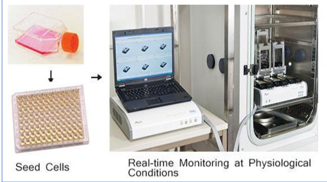
Şekil 2.11. xCELLigence RTCA (gerçek zamanlı hücre analizörü) SP (tek tabakalı)
