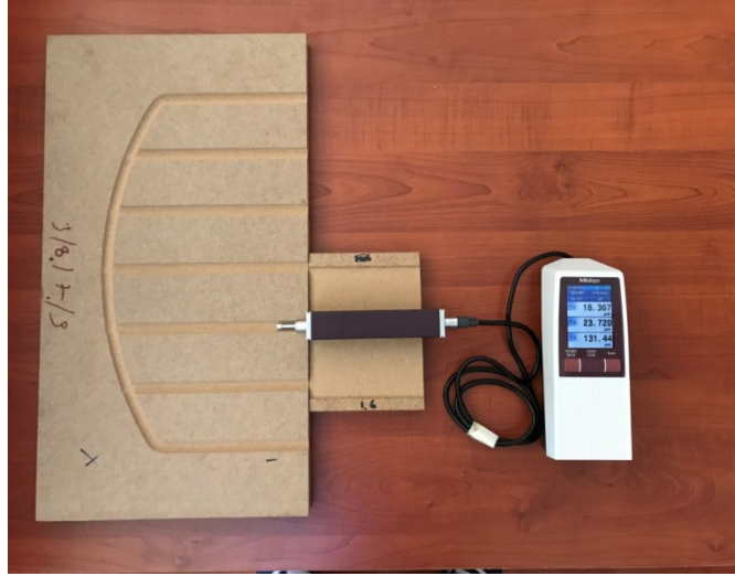
Şekil 3.2 Mitutoyo SJ-210 Model Pürüzlülük Ölçüm Cihazı ve Test Örneği
