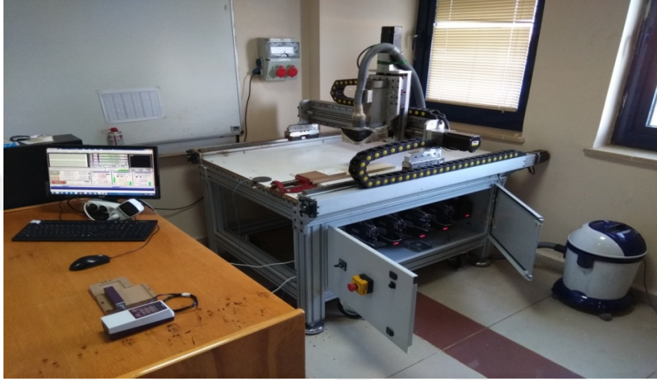
Şekil 3.1 CNC Makinesi, Bilgisayar Kontrolü
