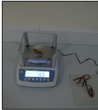
Şekil 3.5 Isomate-C Plus feromon çubuklarının hassas terazide tartım işlemi
