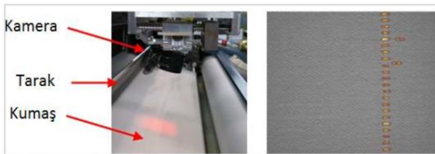
Şekil 0.12. Kumaş hata denetleme sistemi (solda), tespit edilen hata (sağda) (İlhan, 2018)
