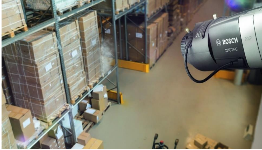
Şekil 0.28. Bosch'un AVIOTEC adlı akıllı yangın algılama sistemi ( www.boschsecurity.com )
