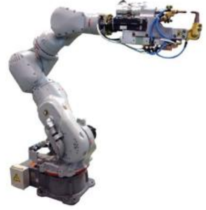
Şekil 0.5. Otomotiv sektöründeki otomasyon ve robotik kaynak uygulamaları (Doruk vd, 2016)
