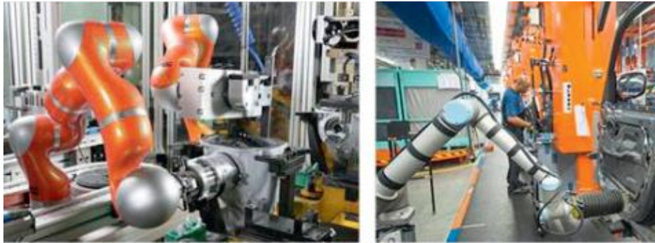
Şekil 0.4. Otomotiv sektöründeki montajda kullanılan çeşitli robotik uygulamaları. (Solda) Mercedes-arka diferansiyel montajı, (sağda) BMW-kapı montajı (Müller, 2014)
