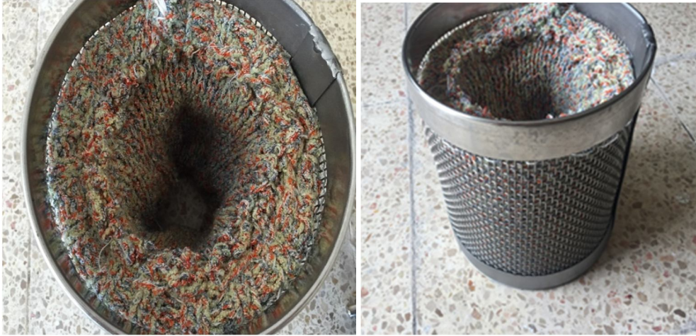
Şekil 4.7 Kurutma numunesi triko ve numune kurutma haznesi
