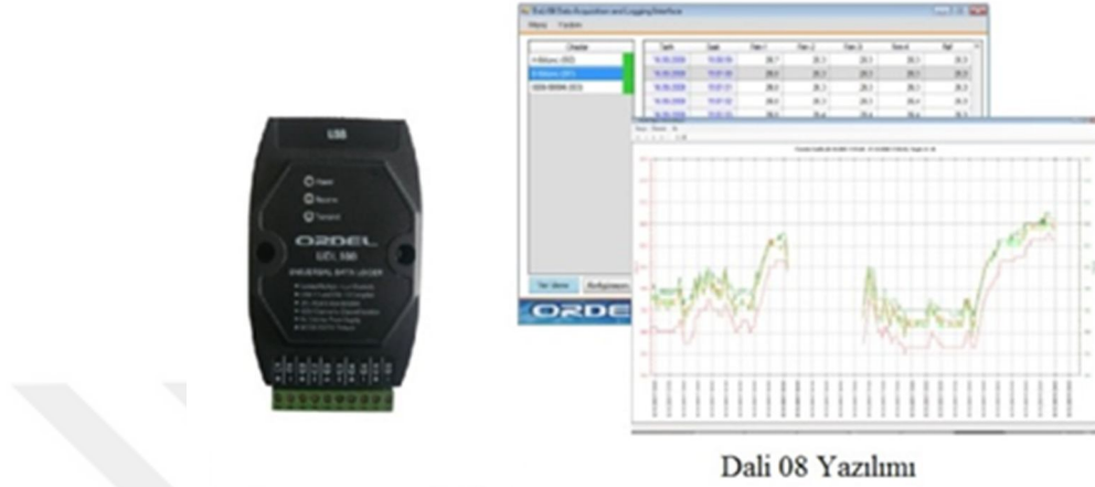
Şekil 4.4 Transmitterler ve veri kaydedici (data logger)
