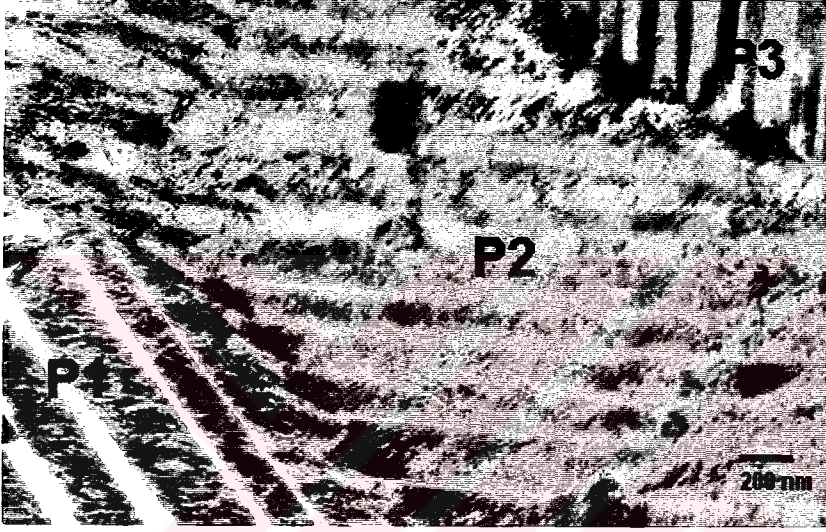
Şekil 3.11. Cu-%11.92Al-%3.78Ni alaşımında martensite plaka grup kombinasyonları (N3)
