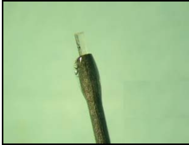
Şekil 2.15. Yapıştırılmış Örnek Kristal
