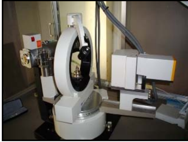
Şekil 2.8. Dört Eksenli Gonyometre
