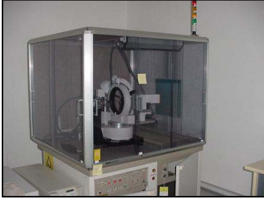
Şekil 2.7. RIGAKU AFC7S Tek Kristal Difraktometresi
