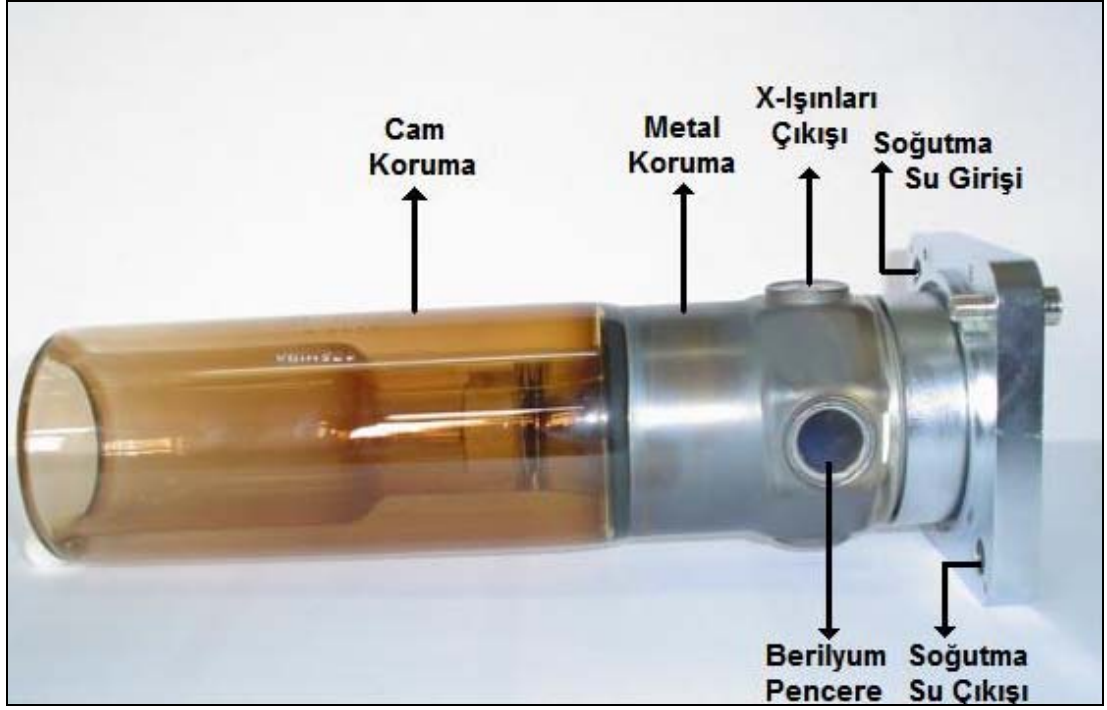
Şekil 2.9. X-Işınları Tüpü (Toshiba)
