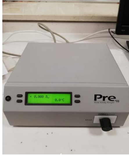
Şekil 3.10. Aqualab Pre su aktivitesi ölçme cihazı
