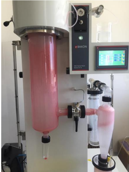
Şekil 3.11. Bakon B15 mini spray dryer
