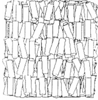
Şekil.1.5. Smektik sıvı kristal fazın yapısı.
