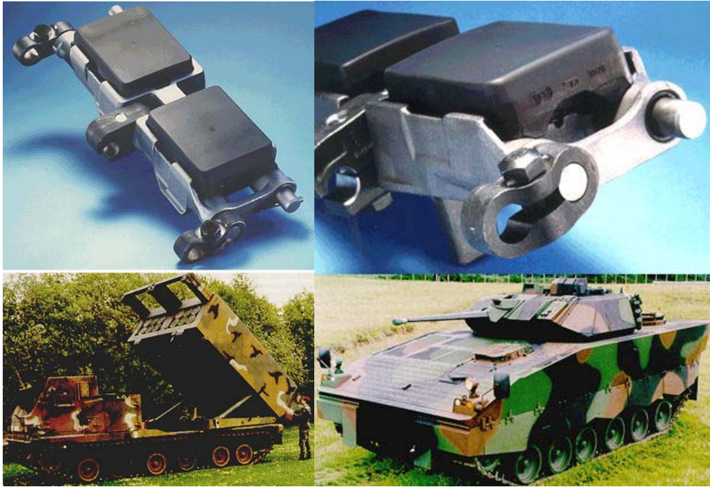
Şekil 3.5. Tank ve ZPT paletleri (11)
