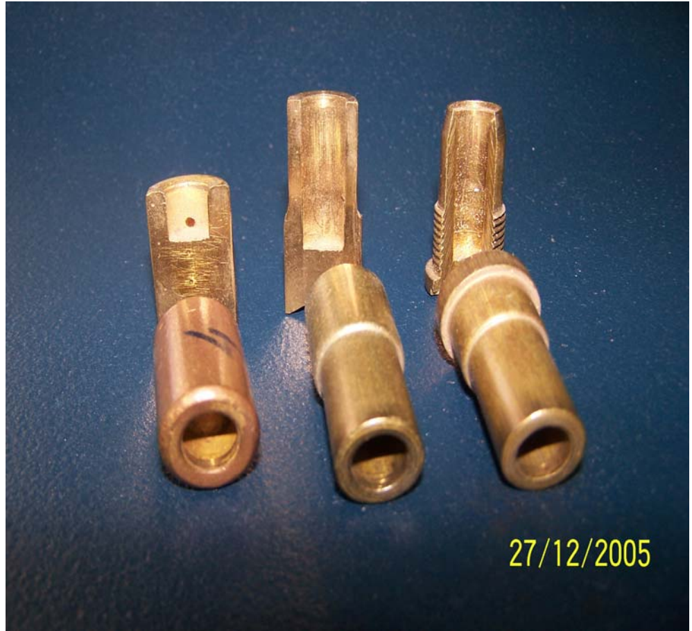
Şekil 3.22. Yapılan imalatta I-II-III çekme operasyonları
