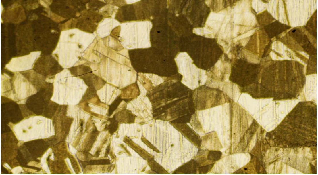
Şekil 3.18. III. Grupta 620 °C de 4 Saat Tavlanan malzemenin parça tane yapısı.
