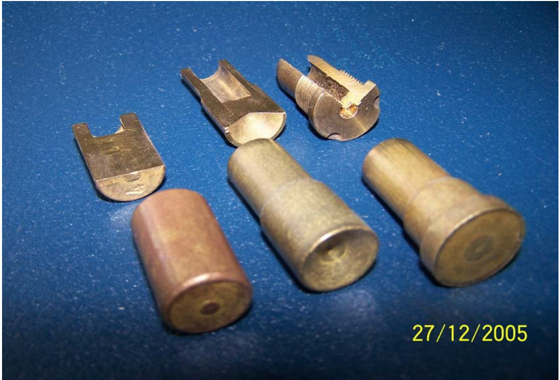
EK-19; I. Çekme - II. Çekme ve III. Çekme sonucunda kalite kontrolden geçmiş sağlam yarı mamuller.
