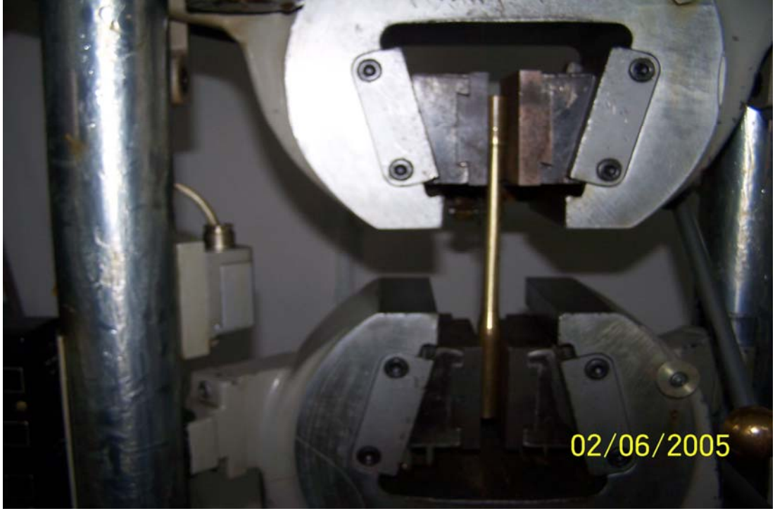
Şekil 3.16. II. grupta 550 °C de 1 Saat Tavlanan malzemenin çekme deneyi
