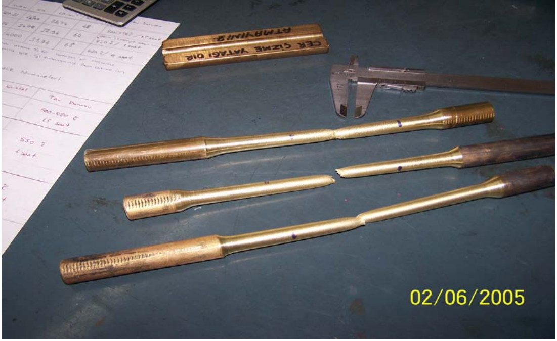
EK-19; I. Çekme - II. Çekme ve III. Çekme sonucunda kalite kontrolden geçmiş sağlam yarı mamuller.
