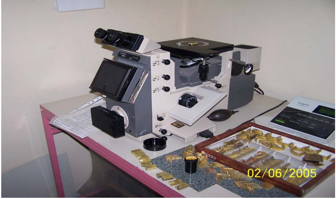
Şekil 3.8. Numunelerin tane yapısına bakılan mikroskop cihazı.
