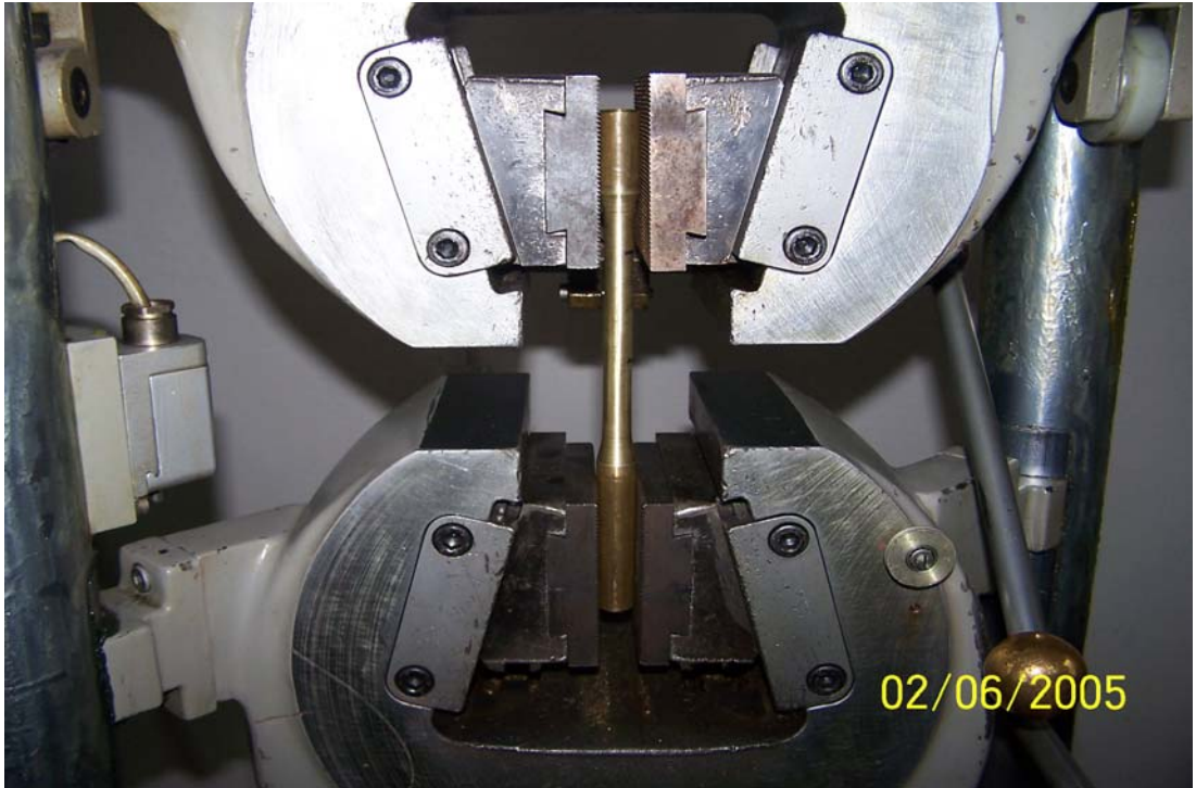
Şekil 3.9. 500 °C de 1,5 Saat Tavlanan malzemenin çekme deneyi.
