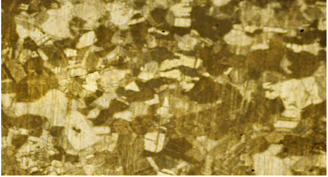
Şekil 3.10. 500 °C de 1 saat 30 dakika tavlanan ve dışarıda soğuması yapılan Numunenin parça tane yapısı.
