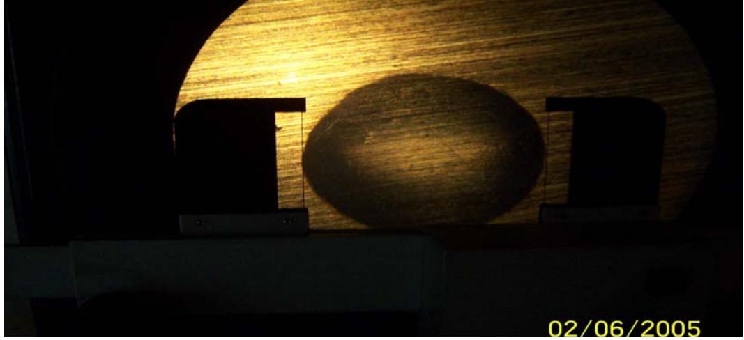
Şekil 3.7. Sertlik ölçümü yapılırken bilya çapının numune üzerindeki görüntüsü
