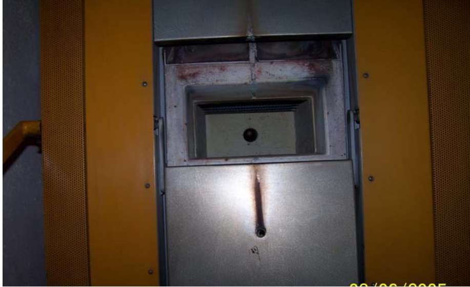
Şekil 3.4. Numune malzemelerin tavlandığı tav fırını
