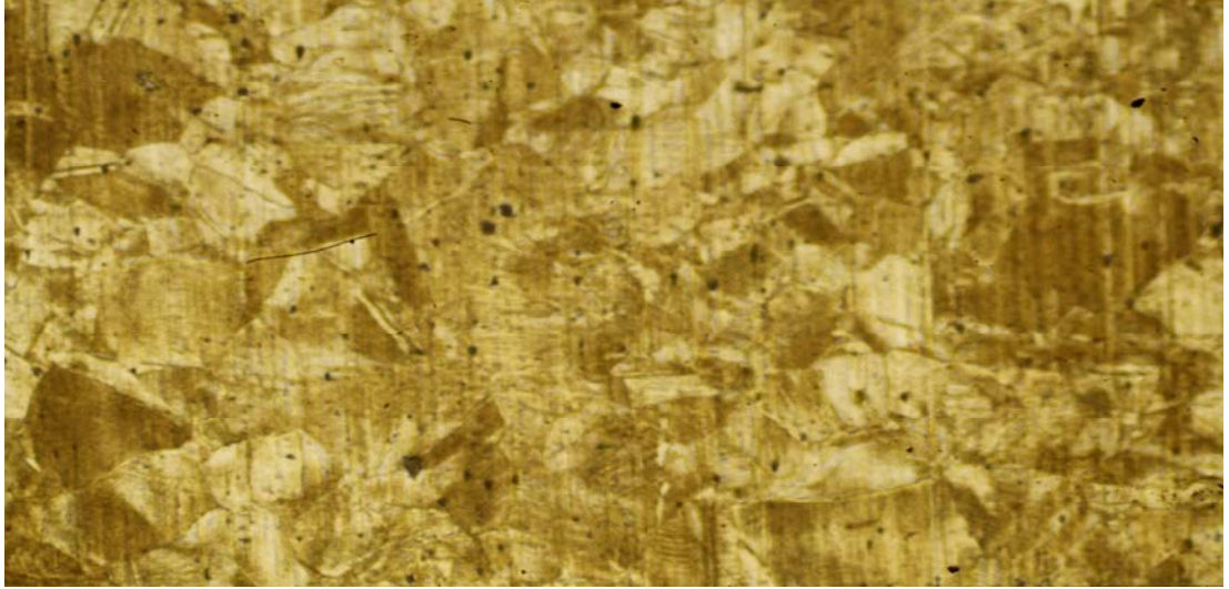
Şekil 3.14 II. Grupta 550 °C de 1 Saat Tavlanan malzemenin parça tane yapısı.
