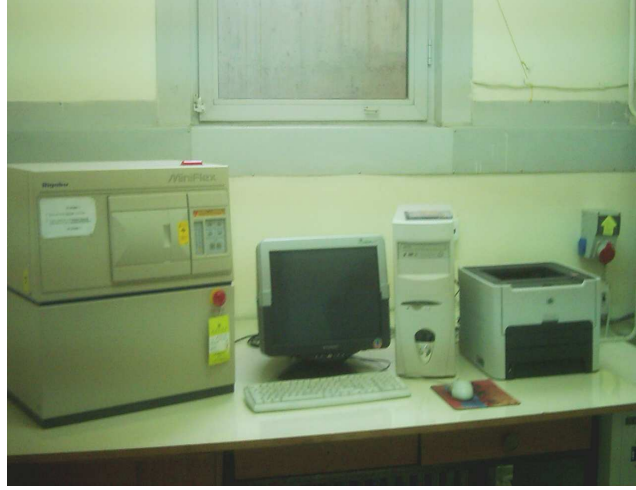
Şekil 2.4. XRD cihazı, Rikagu difraktometre
