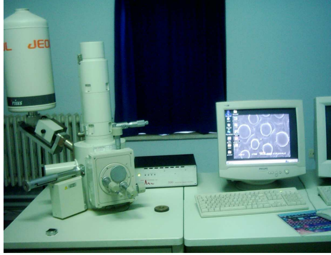
Şekil 2.3. Jeol JSM 5600, Elektron Mikroskobu
