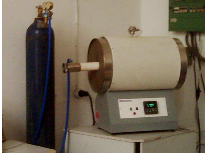
Şekil 2.2. 2416 Euroterm kontrollü Carbolite marka fırın
