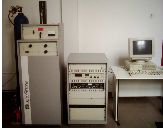
Şekil 2.7. 7130 Lake Shore AC, Manyetik Alınganlık Ölçüm Sistemi
