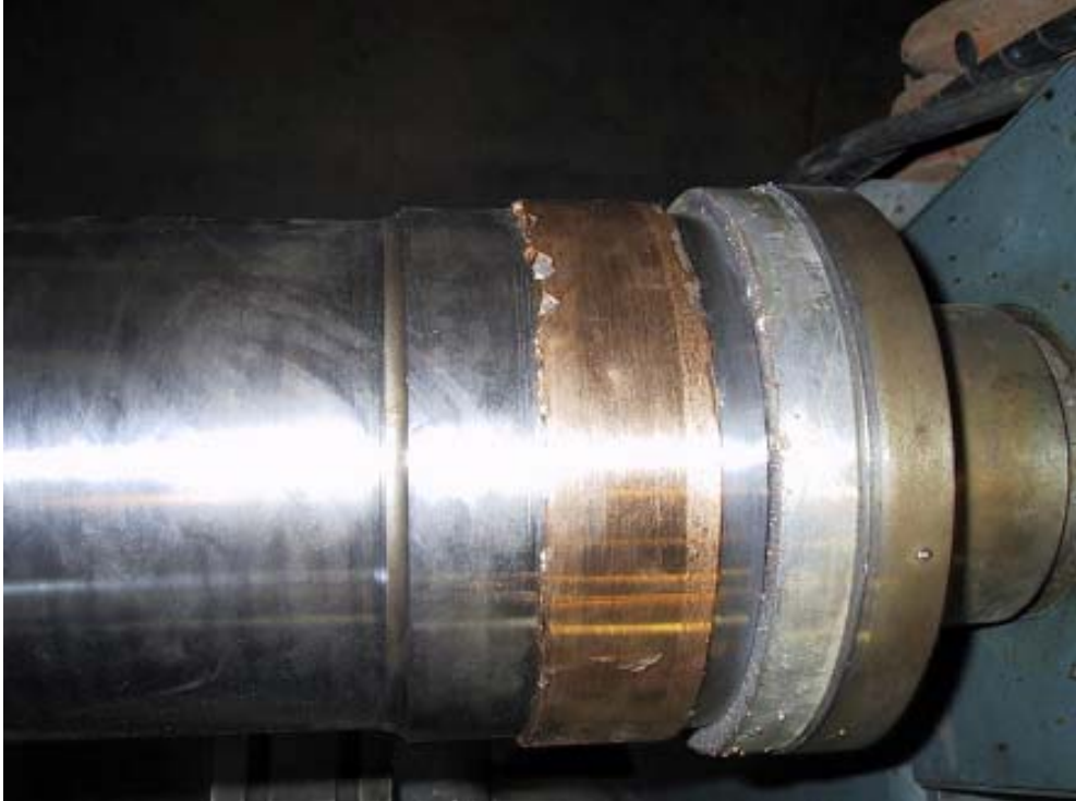
Şekil 3.2.b Kaynak sonrası iş parçasının kaba tornası
