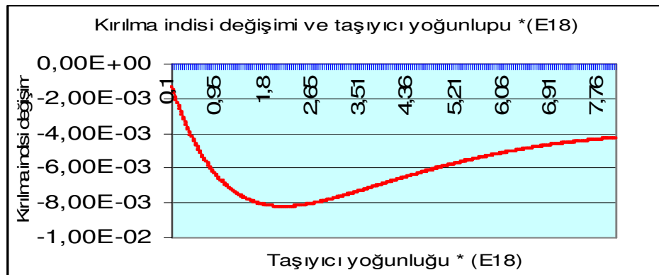
Şekil 3.1.17. Kırılma indisi değişimi ve taşıyıcı yoğunluğu ilişkisi
