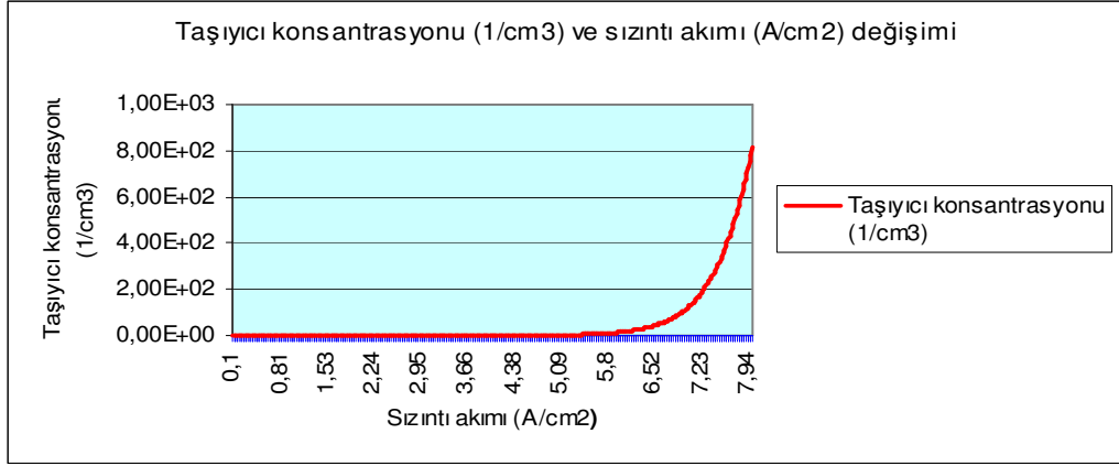
Şekil 3.4.12. Sızıntı Akımı (A/cm 2 ) ve taşıyıcı yoğunluğu (1/cm 3 ) ilişkisi
