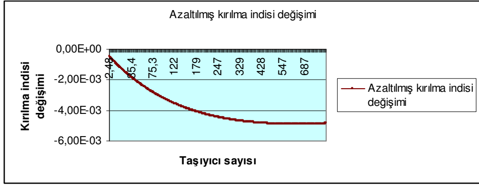
Şekil.3.7.10. Taşıyıcı sayısına göre azaltılmış kırılma indisi değişimi
