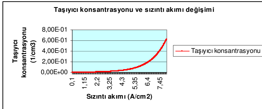
Şekil.3.7.11. Taşıyıcı konsantrasyonu' na göre sızıntı akımı değişimi
