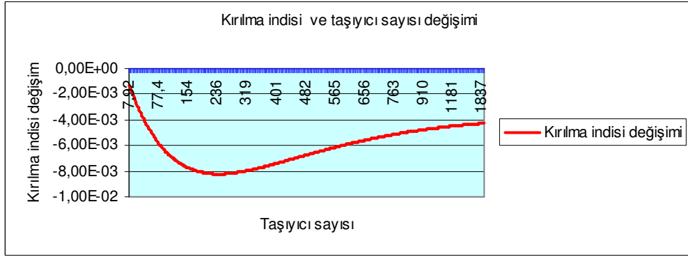
Şekil 3.4.13. Taşıyıcı sayısı ve kırılma indisindeki değişme ilişkisi
