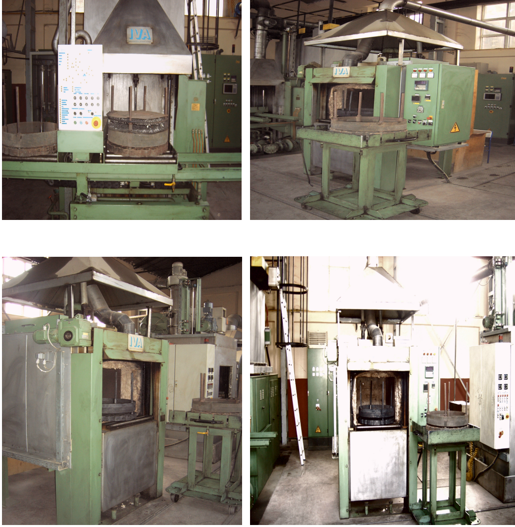
Şekil 3.2. Gaz Sementasyon Fırınları ve Isıl İşlem Ocakları
