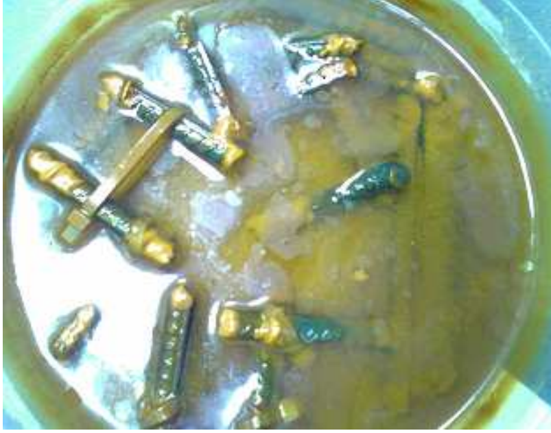
Şekil 2.7 Korozyona Bırakılmış Deney Numuneleri (Katot ucuna bağlanmamış)
