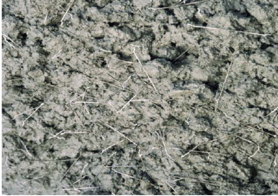
Şekil 2.6. Çelik Tel Donatılı Beton Karışımı
