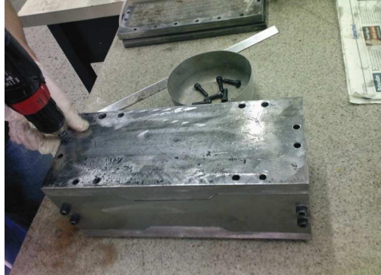
Şekil 2.16. Üst (1) plakasının sökülmesi işlemi
