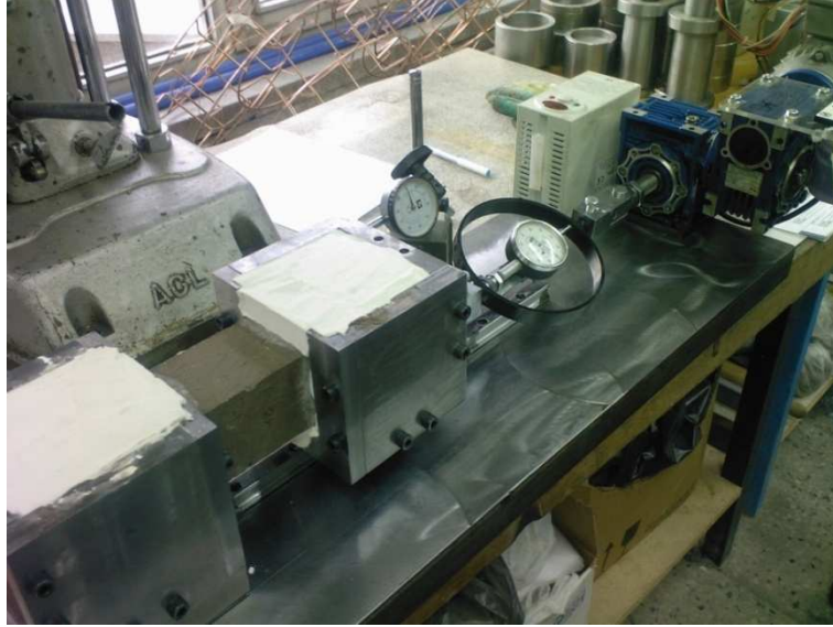
Şekil 2.29. Boşluklar alçı ile doldurulduktan sonra
