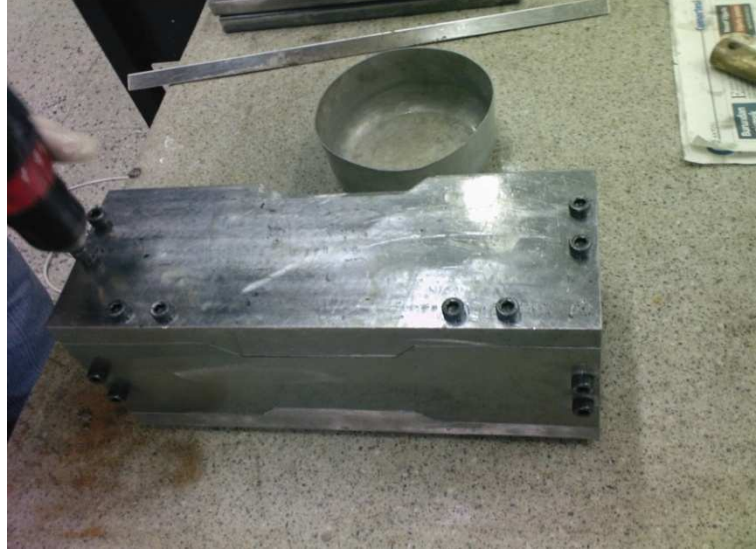
Şekil 2.17. Üst (3) plakasının takılması işlemi
