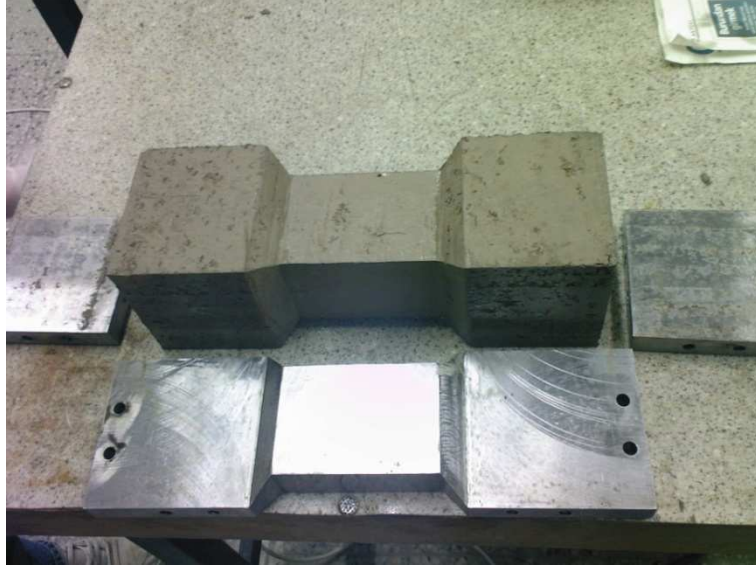
Şekil 2.24. Tüm tıraşlama işlemlerinden sonra kalıplardan çıkartılan numune
