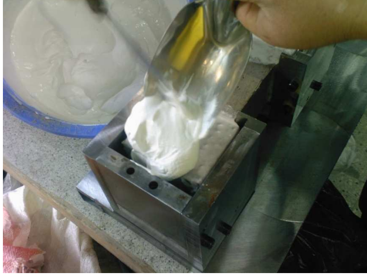
Şekil 2.28. Kenarlardaki boşlukların alçı ile doldurulması
