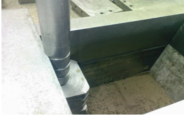
Şekil 2.7. Tabaka kalınlığının kontrol edilmesi
