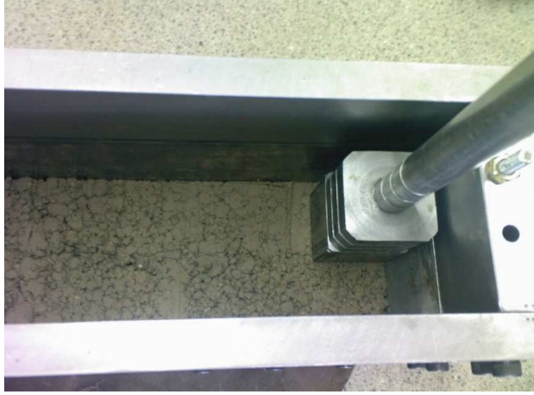
Şekil 2.6. Tokmaktama ile kalıp içerisindeki zeminin sıkıştırılması işlemi
