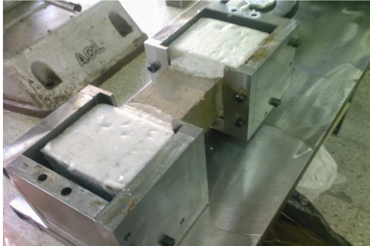
Şekil 2.27. Çekme kalıbına yerleştirilmiş uçları parafinli numune
