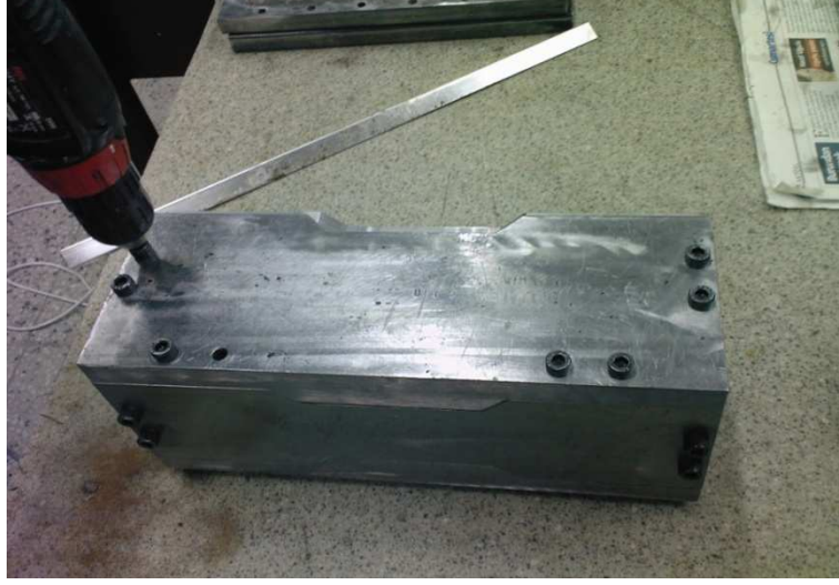
Şekil 2.15. Üst (2) plakasının takılması işlemi
