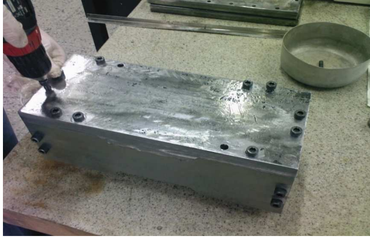
Şekil 2.13. Üst (1) plakası takılması işlemi
