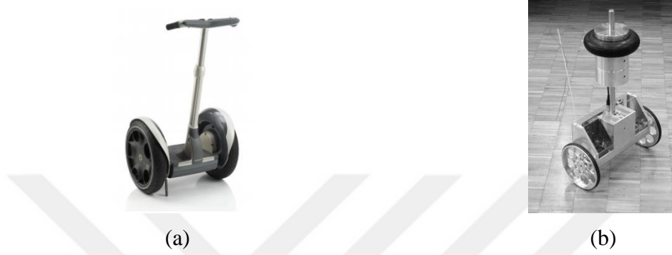
Şekil 2.2. İki tekerlekli robot modelleri; (a) Kişisel segway robotu, (b) "Joe" isimli robot
