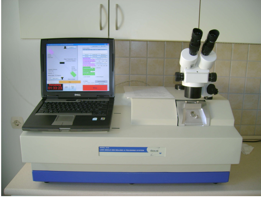
Şekil 2.11 Kırıkkale Üniversitesi bünyesine “106T043” numaralı TÜBİTAK projesi kapsamında alınan FISCHIONE Model 1010 iyon değirmeni.
