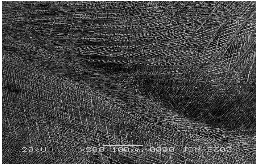
Şekil 3.7. Isıl işlem sonrası basma zoru uygulanmış A3 örneğinin SEM fotoğrafları
