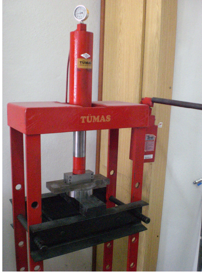
Şekil 2.4 TUMAS marka, maksimum 40 MPa'lık hidrolik pres
