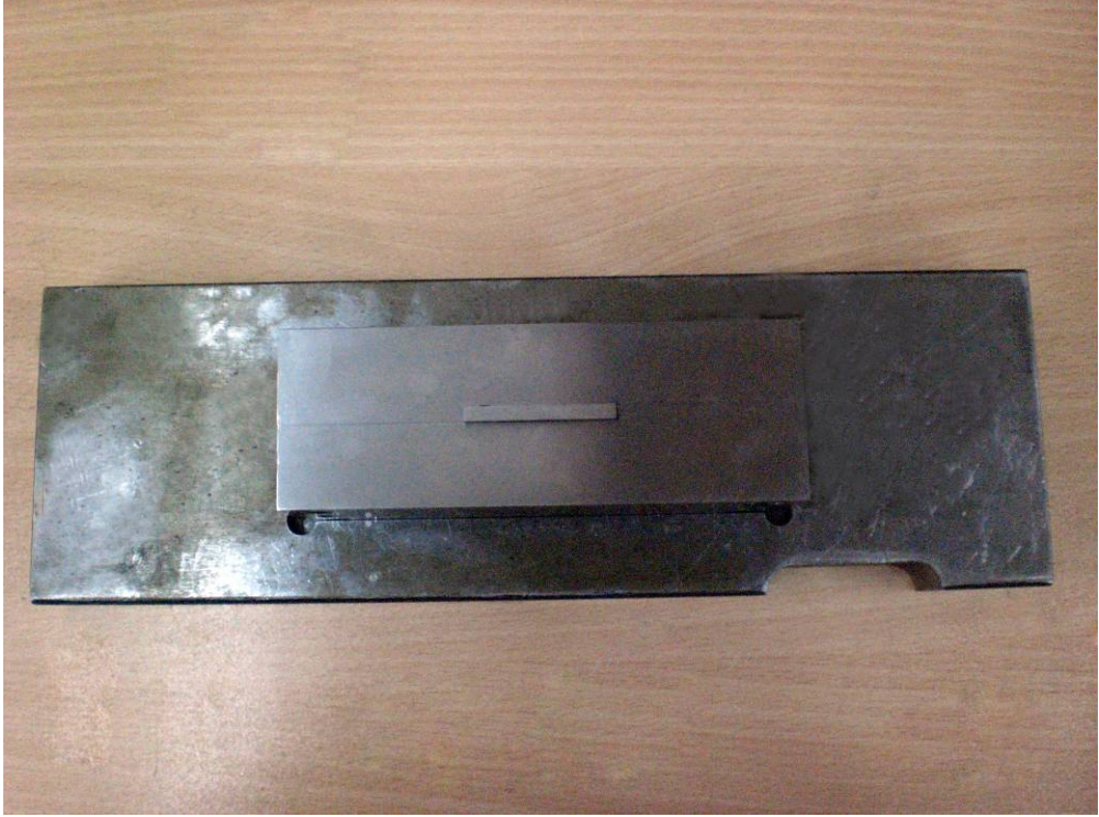
Şekil 2.3 Yaklaşık 4 cm uzunluğunda, 4 mm genişliğinde, 2 mm derinliğinde olan çelik kalıp
