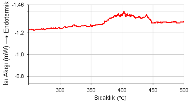
Şekil 3.14. 1100 °C sıcaklığında 6 saat ısıtma işlemi uygulanan Fe-%30Ni-%1Pd-%1Mo alaşımının ikinci döngüsünün (ısıtma) sıcaklığa bağlı ısı akışı değişimi.
