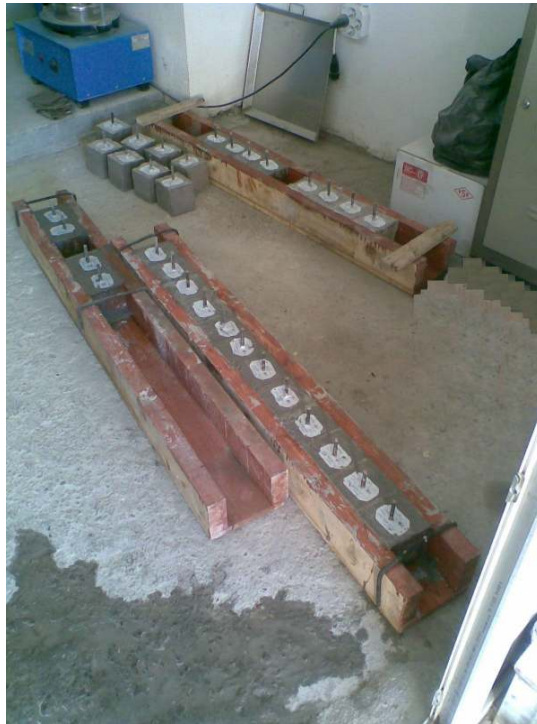
Şekil 2.18. Aderans deneyi için hazırlanmış küp numuneler
