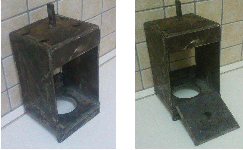
Şekil 2.21. Çekme kalıbı ve 2 cm delik çaplı çelik plaka
