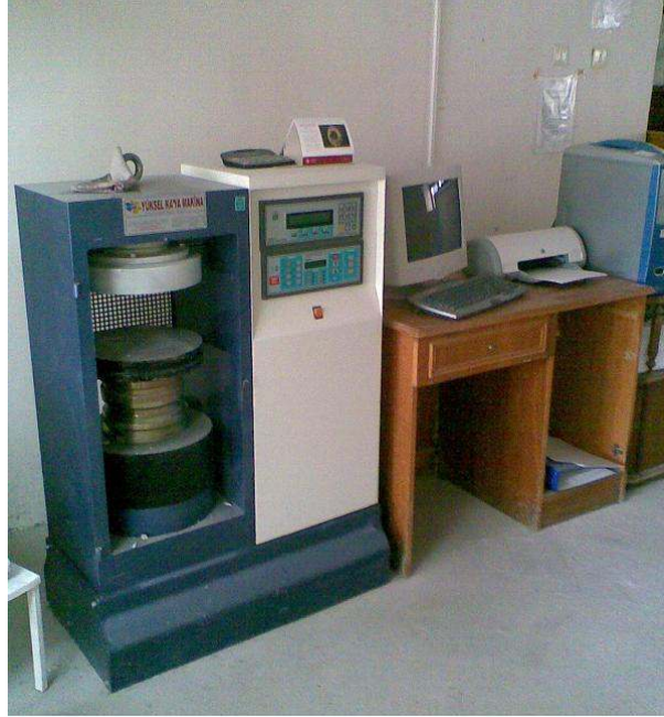
Şekil 2.19. 2000 kN kapasiteli beton test presi
