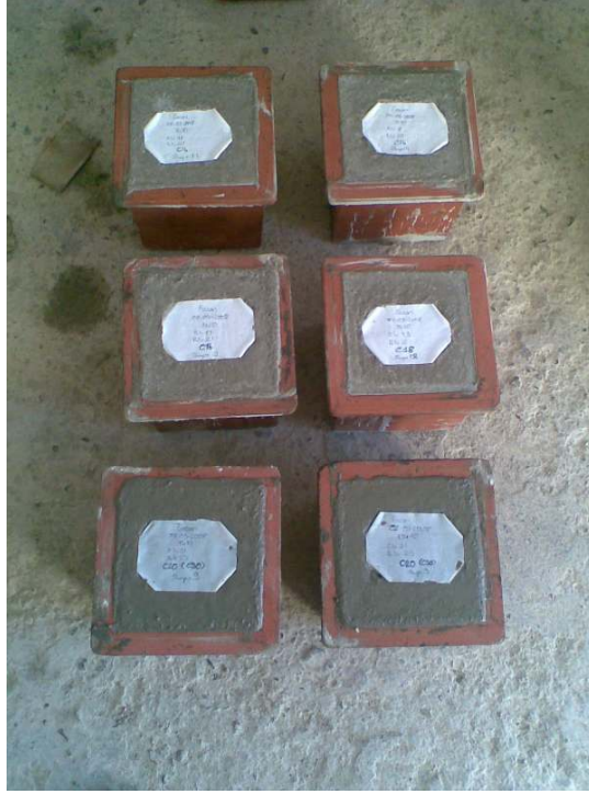
Şekil 2.17. Basınç deneyi için hazırlanmış küp numuneler
