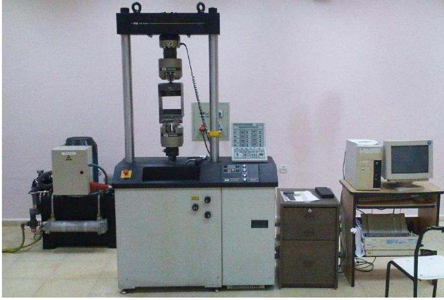
Şekil 2.20. Instron 8516 yorulma test cihazı ve çelik kalıp
