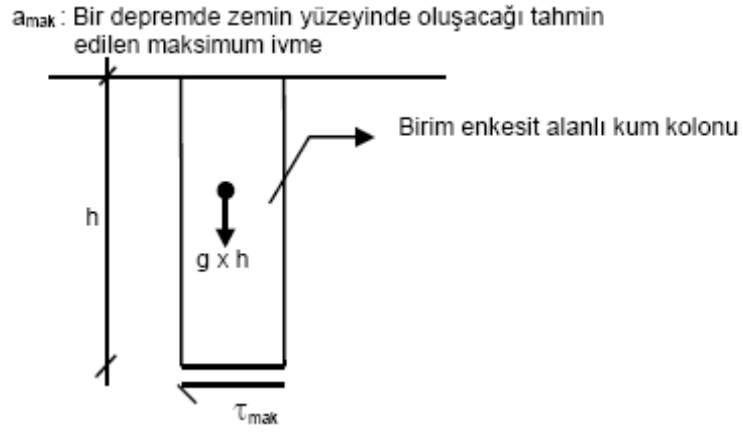
Şekil 3.4 Birim en kesit alanlı kum kolonunda oluşan kayma gerilmesi( \tau_{\max} )
