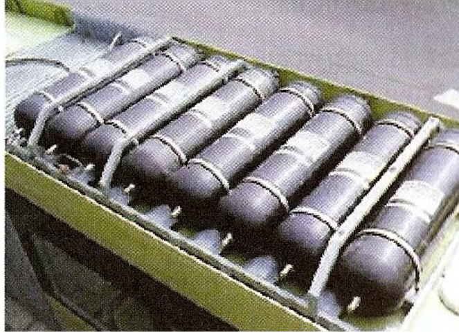
Şekil 2.5. Otobüslerde kullanılan CNG tankları (7)
