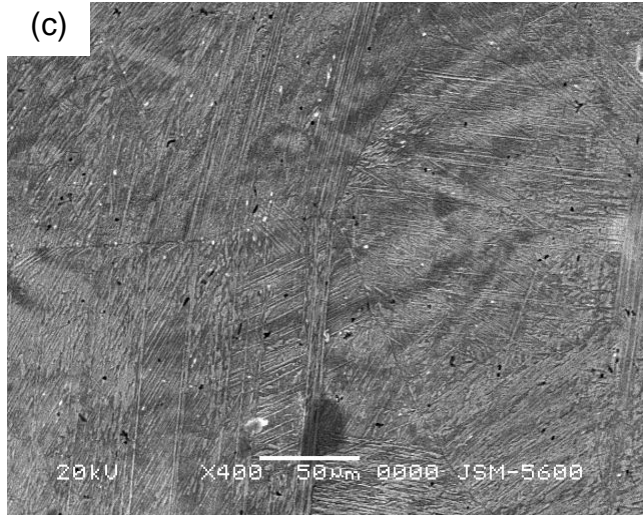
Şekil 3.5. Farklı yaşlandırma işlemine tabii tutulan numunelerin SEM resimleri (a) 300°C 20 dakika, (b) 300°C 2 saat, (c) 300°C 24 saat, (d) 400°C 24 saat, (e) 500°C 24 saat
