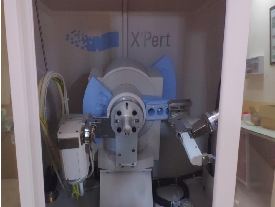
Şekil 3.6. X'Pert PRO marka XRD cihazı iç görünümü
