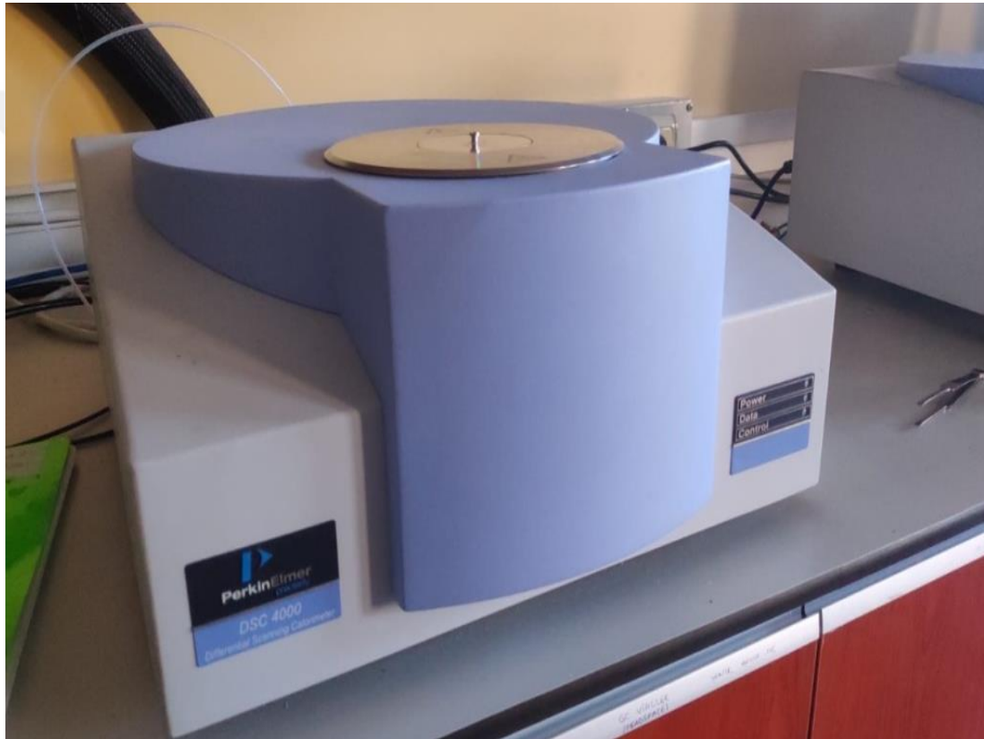
Şekil 3.3. Perkin Elmer marka DSC 4000 Model Diferansiyel Taramalı Kalorimetre Cihaz
