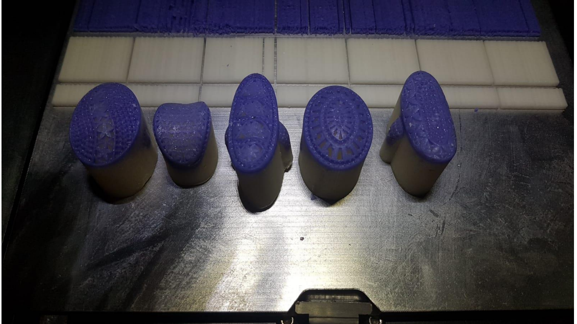
Şekil 3.11. Matrix programında çizilen yüzüklerin 3D yazıcı iç görünümü
