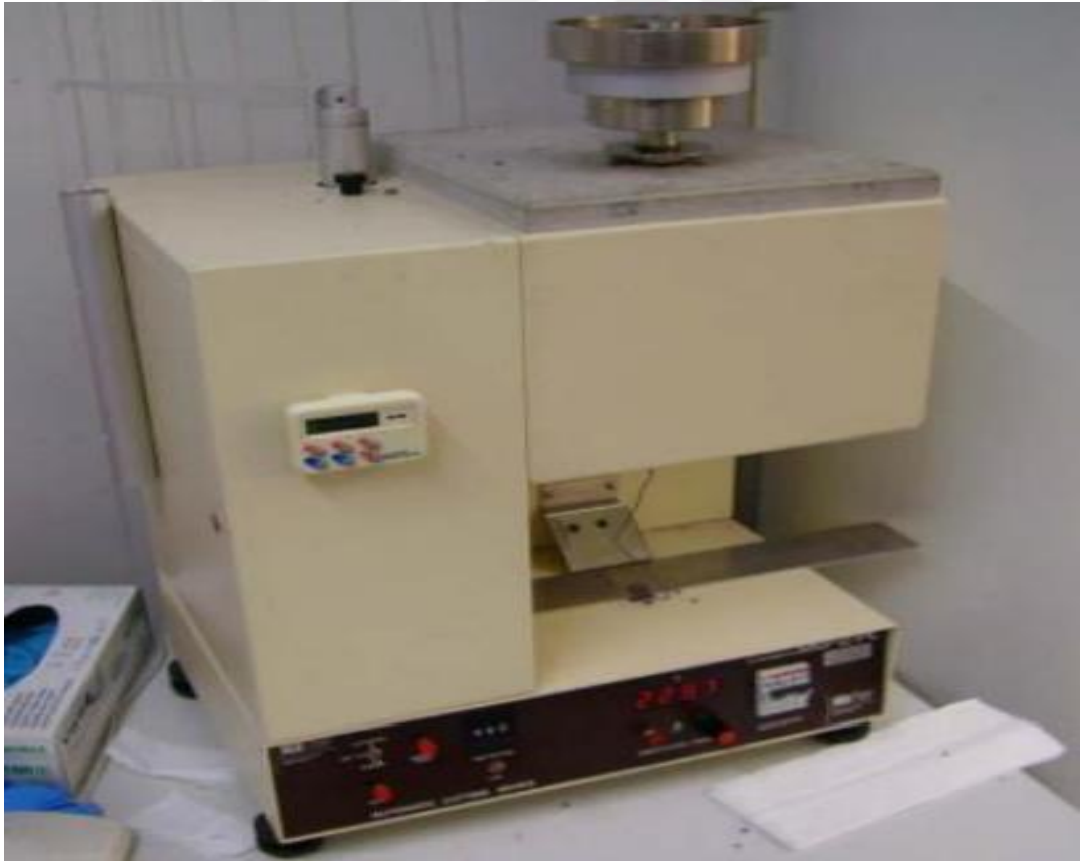
Şekil 2.9. Erime akış indeksi plastomeri (Hamod, 2014)
