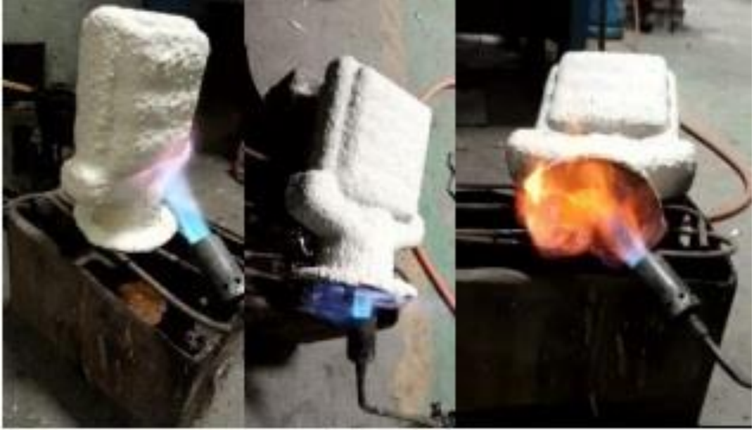
Şekil 2.7. Flament eritme işlemi
