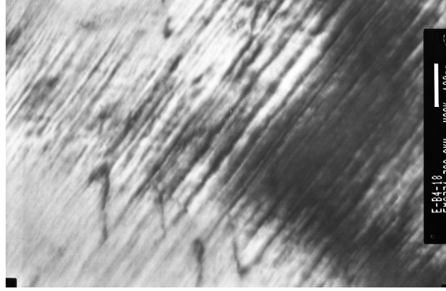
Şekil 3.5.a. Fe-%30Ni-%1.8Ti alaşımında martensite plakanın ikizlenmiş bölgesinin aydınlık alan görüntüsü (X 80K, ölçek boyutu:100nm).
