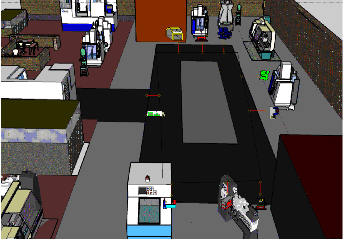
Şekil 6.3. Önerilen EİS hücresi yerleşim düzeninin görsel modeli
