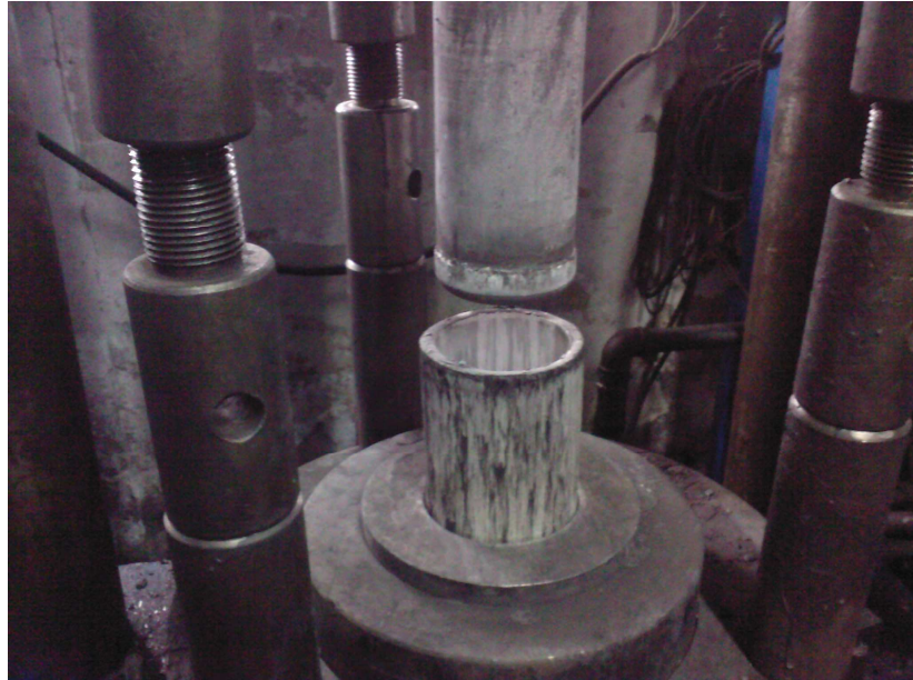
Şekil 3.3. Kalın sacın derin çekme presinde çekilmiş hali
