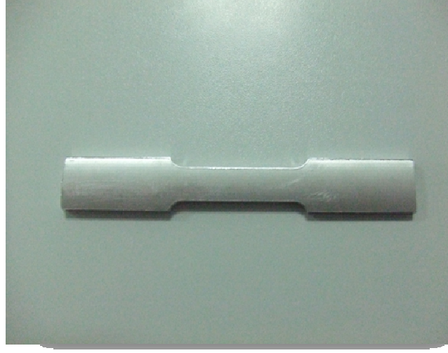
Şekil 2.1. 6061-T6 alüminyum tanka ait çekme numunesi
