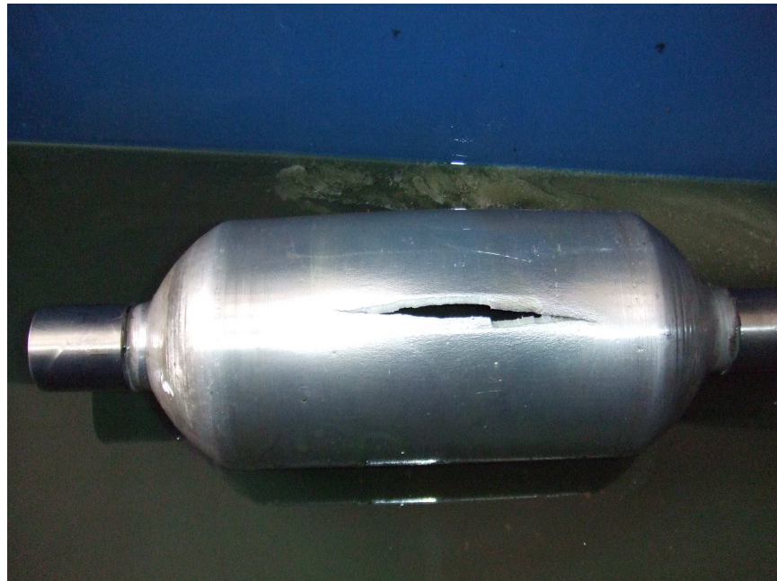
Şekil 4.2. Metal astarın patlatma deneyi sonucu hasara uğramış hali
