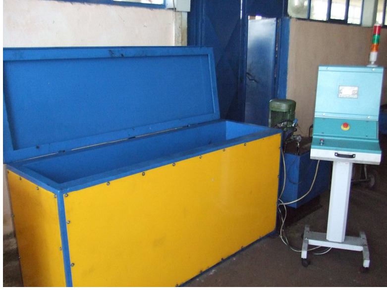
Şekil 3.6. PLC kontrollü, servo motorlu hidrolik test cihazı
