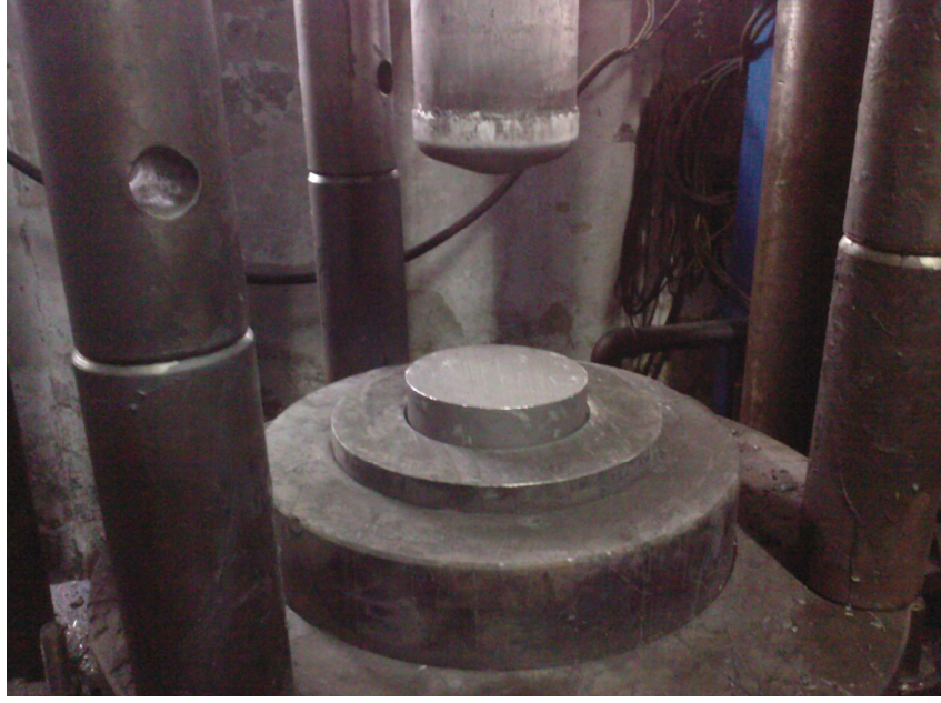
Şekil 3.2. Derin çekme presinde kalıp içindeki kalın sac
