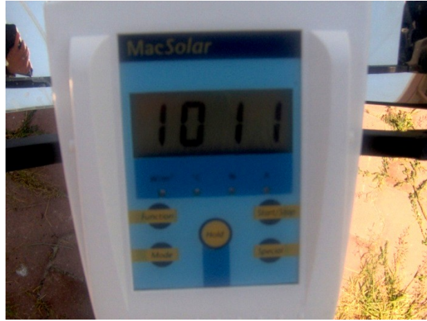
Şekil 6.1. Deneyde kullanılan akı ölçer ile herhangi bir anda yapılan ölçüm
