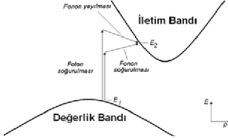
Şekil 4.7. Dolaylı geçişli yarıiletkende foton soğurulması
