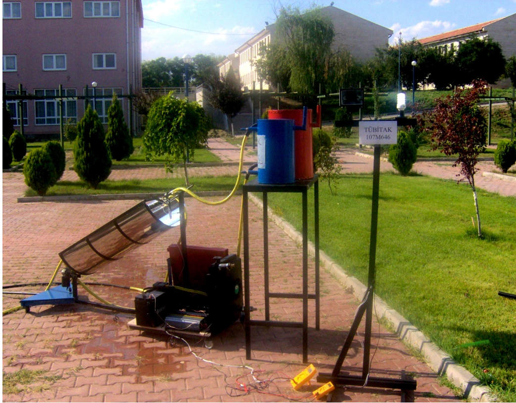
Şekil 6.3. Geliştirilmiş su soğutmalı deney düzeneği ile açık havada elektrik enerjisi elde edilmesi
