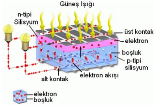
Şekil 4.10. Güneş pilinin çalışma prensibinin gösterimi
