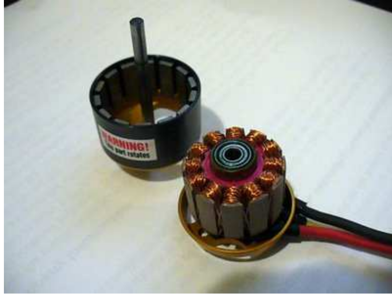
Şekil 2.17. Dıştan rotorlu fırçasız DC motor
