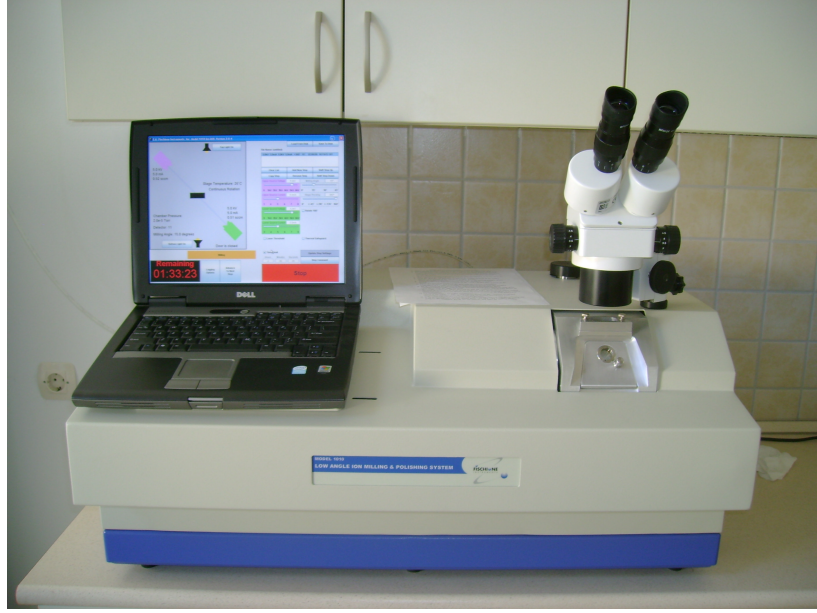
Şekil 2.14. TEM numunelerinin hazırlanmasında kullanılan Fischione 1010 model iyon değirmenin resmi
