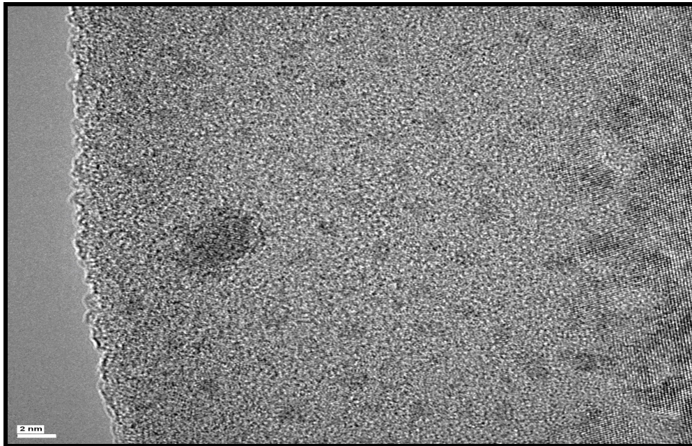
Şekil 3.2. 900 °C de t=30 dakika süreyle tavllanmış 60 sccm Ge katkılı Al1 numunesi için farklı bir bölge elde edilen TEM görüntüsü
