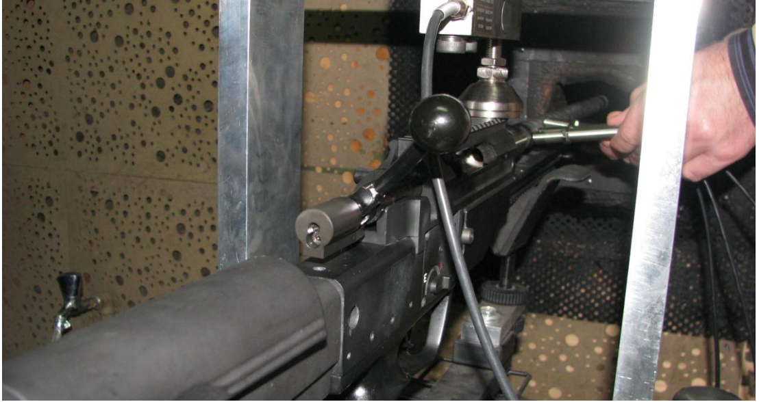
Şekil 3.8. Sıcaklık ölçümü için kompozit desteklinamlunun test cihazına bağlanması.
