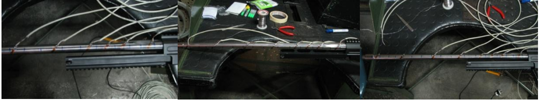
Şekil 3.7. Gerinim pullarının orijinal namluya yapıştırılması.
