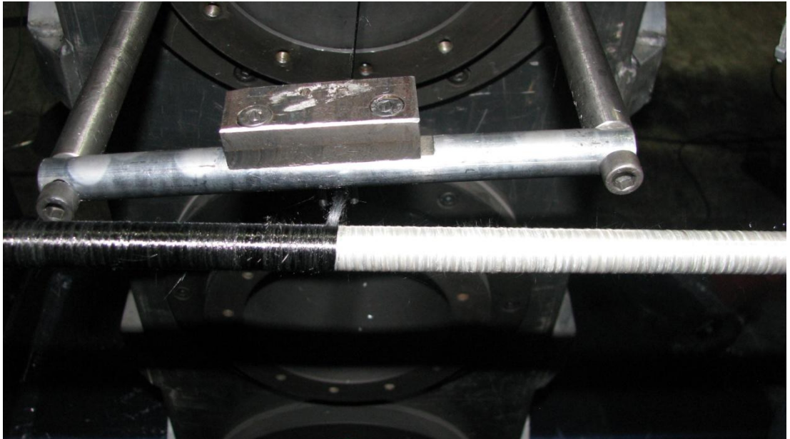
Şekil 3.11. Karbon/Epoksi sarım işlemi.
