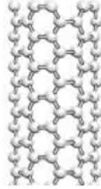
Şekil3.3.2.1.Oluşum Yönüne göre sandalye kolu geometrili nanotüp yapısı
