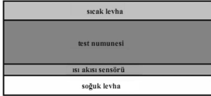
Şekil 2.11. Isı akış metre metoduna göre ölçüm yapan deney cihazı şematik görünüşü
