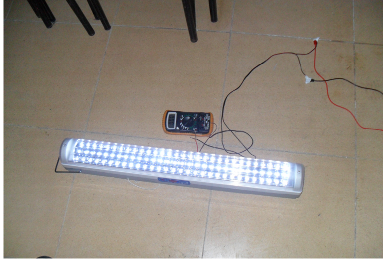
Şekil 6.2. Termoelektrik jeneratörden sağlanan gerilimle yakılan 90 LED’li lamba
