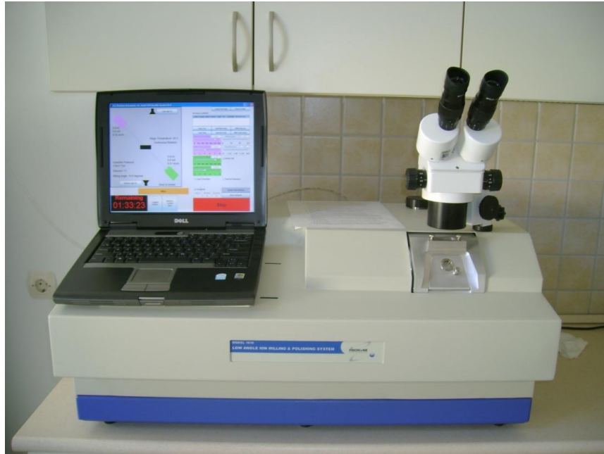
Şekil 2.24. Numune inceltme işleminde kullanılan FISCHIONE Model 1010 iyon değirmeni.
