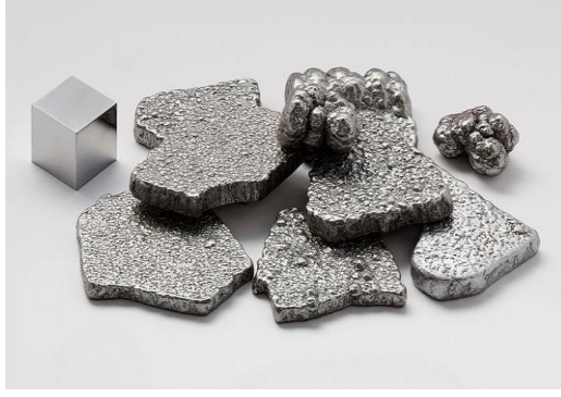
Şekil 2.17. Elektrolizle arıtılmış (%99,97+) saflıkta demir parçaları ve karşılaştırma için yüksek saflıkta (99,9999 % = 6N) 1 cm 3 hacminde demirden bir küp
