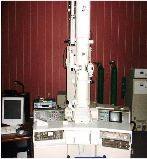
Şekil 2.21. Geçirmeli Elektron Mikroskobu (TEM) ve Yapısı
