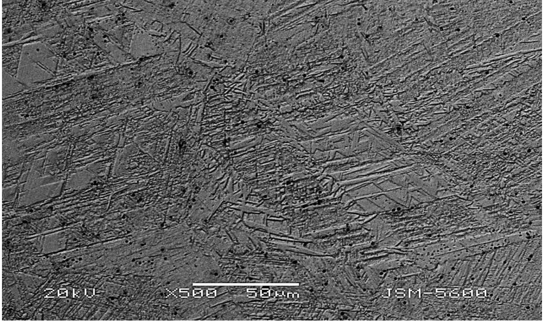
Şekil 3.8. 1200°C sıcaklıkta 12 saat tavlanan ve suda hızlı soğutulan Fe-%17,3Mn-%4,6Co alaşımına ait yüzey görünümü
