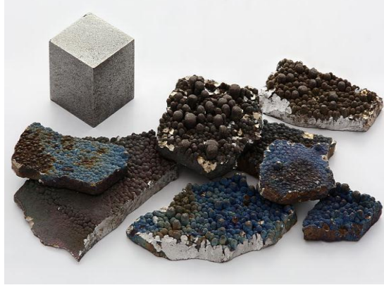
Şekil 2.18. Elektrolizle arıtılmış (%99,99) saflıkta mangan parçaları ve karşılaştırma için yüksek saflıkta (%99,99 = 4N) 1 cm 3 hacminde mangan bir küp
