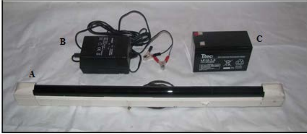
Şekil 2.4. Gece yapılan arazi çalışmalarında akrep toplanmasında kullanılan malzemeler. A. Phillips TL-D18W/BLB UV lamba takılmış armatür. B. Akü Şarj Aleti. C. 12 voltluk kuru akü
